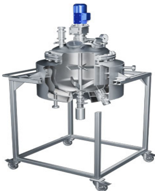
Рис. 8.15. Лабораторный 10 л химический реактор из нержавеющей стали. Расположение перемешивающего устройства – вертикальное; установленная мощность 3,0–45 кВт; скорость вращения мешалки, 0–18000 об/мин; основной материал сталь 12X18H10T или AISI 316; рабочее давление пара в рубашке 0,2–0,4 МПа; рабочее разрежение пара в корпусе аппарата – до 0,03 МПа
