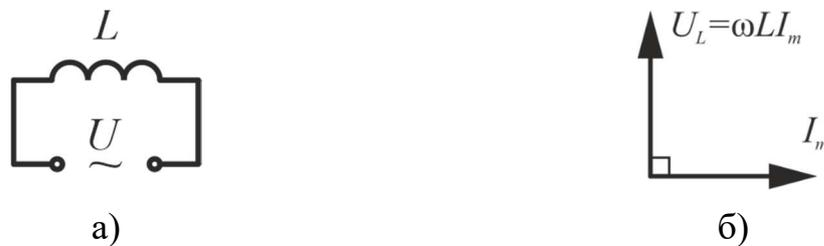
**Рис.3.** Электрическая цепь с идеальной индуктивностью. а) схема; б) векторная диаграмма тока и напряжения на катушке индуктивности
