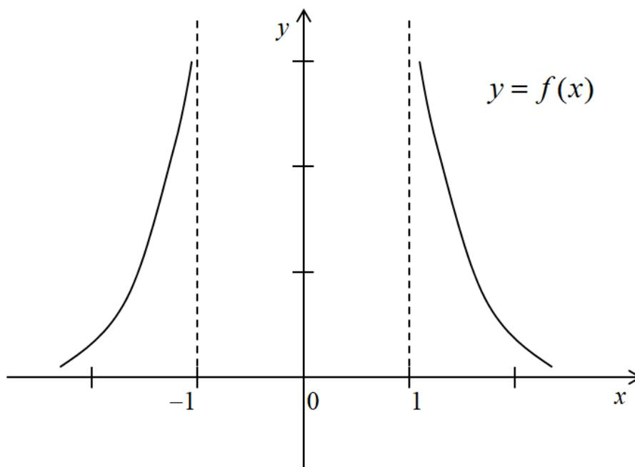
**Рис.5.** Функция  $y = f(x)$ , имеющая разрыв второго рода в точках  $x_{1,2} = \pm 1$
