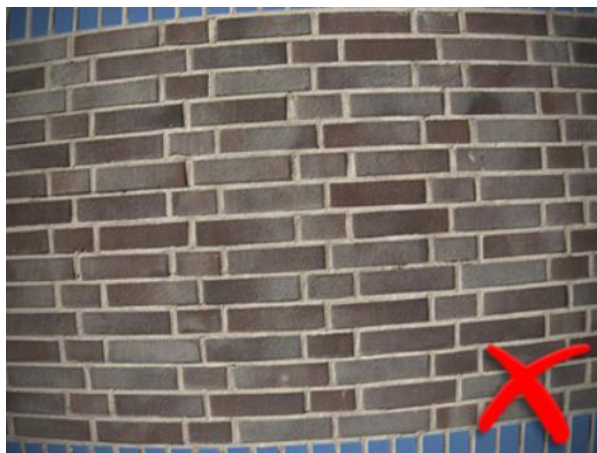
Рис 5.10 Пример снимка с камеры, объектив которой имеет сильную дисторсию.
