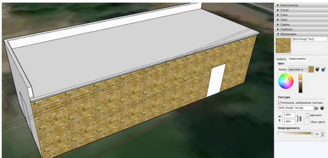
Рис 4.17. Наложение текстуры на грань каркасной модели.
