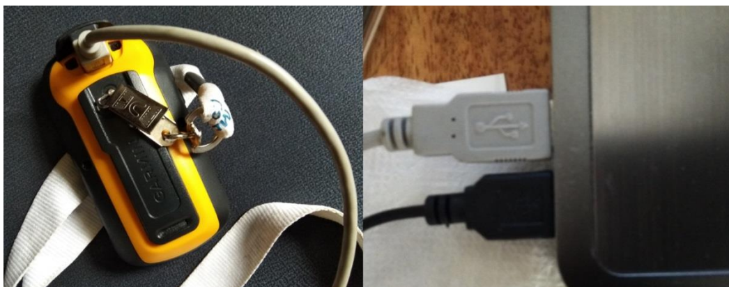
Рис. 1.8.6. Подключение GPS-навигатора к рабочей машине
