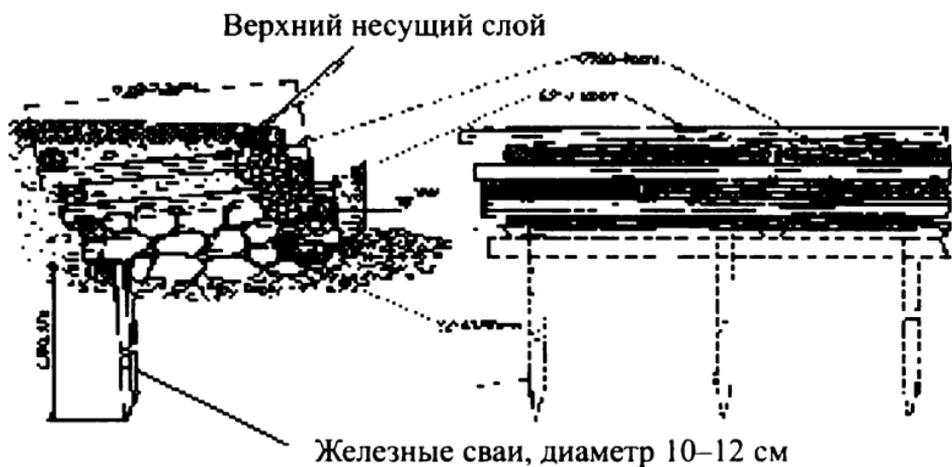
РИС. 47. Подпорная стена, укрепленная фашинами и камнями.
