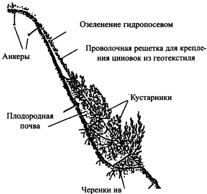
РИС. 89. Укрепление склона геотексителем.
