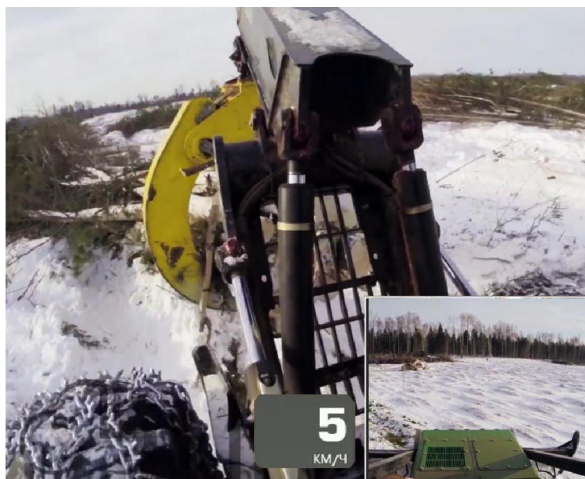
Рис. 3.14. Фрагменты проведения экспериментальных исследований на колесном скидере JohnDeere 748H, полученные с измерительного комплекса Racelogic Vbox
