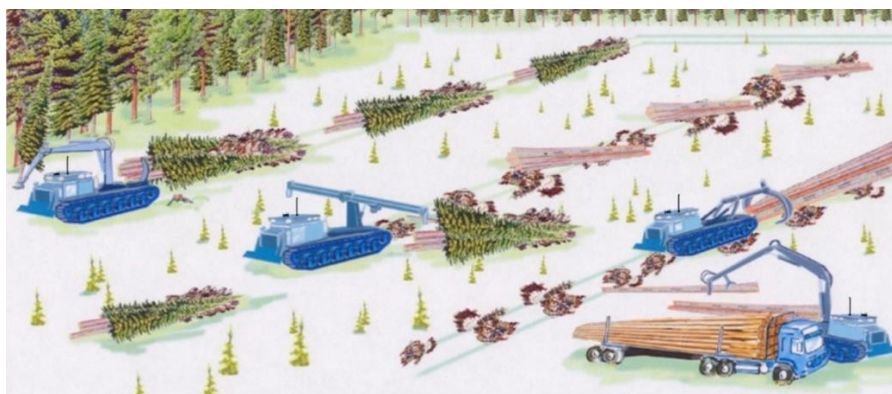
Рис. 1.8. Схема процесса заготовки хлыстов с созданием укрупнённых пачек для трелёвки с укреплением волока отходами древесины
