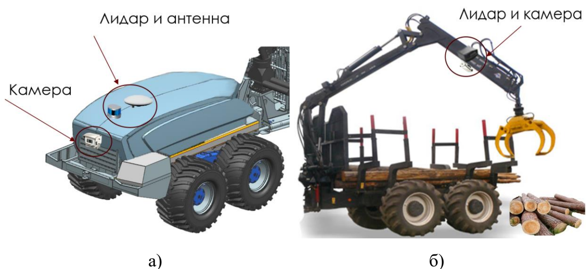
Рис. 1.82. Компоновка установки измерительных устройств внешней сенсорной сети на передний и задний модуль колесной беспилотной ПТМ: а) моторно-трансмиссионный модуль (передний); б) технологический модуль (задний)
