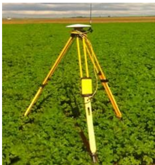
Рис. 1.46. Базовая станция GPS/ГЛОНАСС
