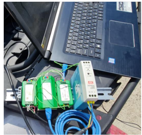
Рис. 3.7. Программно-измерительный комплекс определения угловой скорости вращения ведущих колес гусеничного трелевочного трактора
