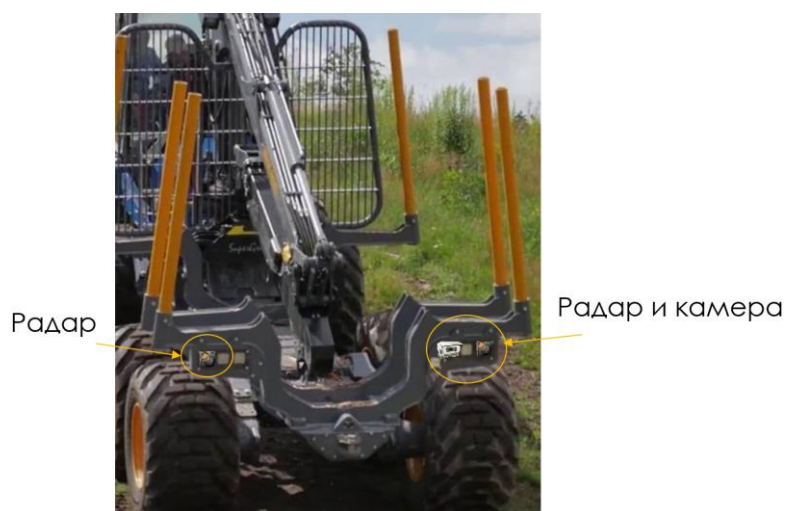
Рис. 1.83. Установки измерительных устройств внешней сенсорной сети на задний модуль колесной беспилотной ПТМ
