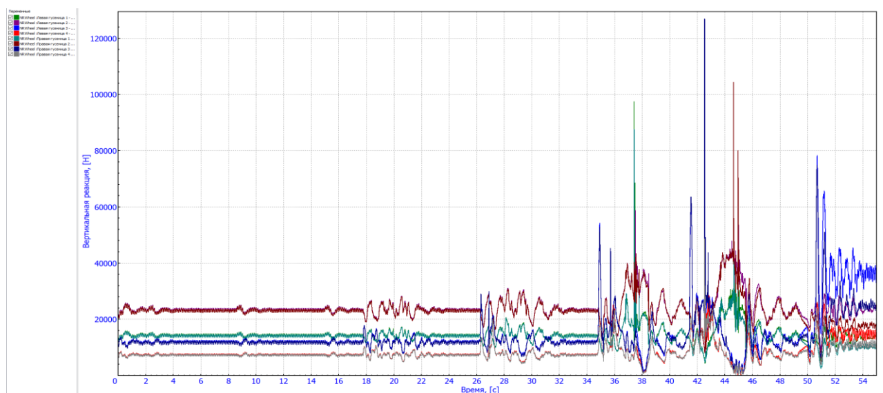
Рис. 6.19. Изменение вертикальных реакций под катками БПТМ с коником при преодолении препятствий в виде поваленного дерева (0,5 м не преодолела)
