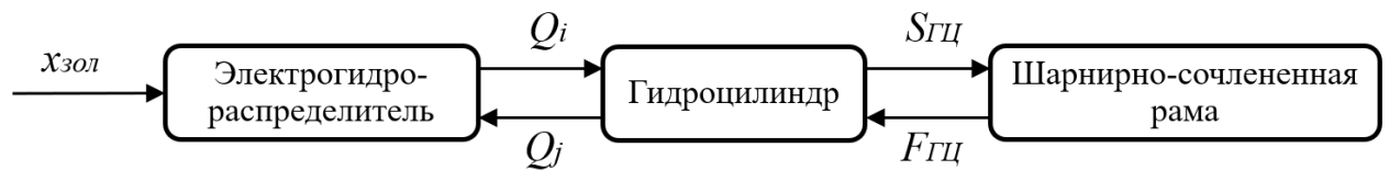
Рис. 5.6. Структурная схема гидропривода складывания полурам колесной СБПТМ
