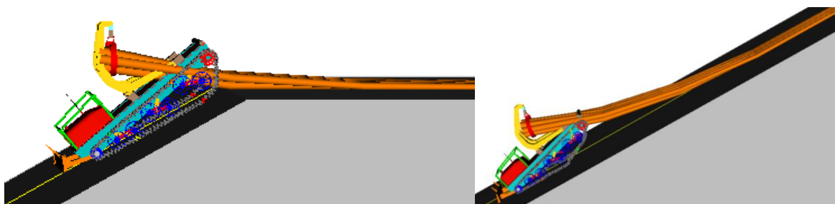
Рис. 6.9. Этапы перемещения гусеничной БПТМ с пачковым захватом при потере подвижности на 30-градусном спуске (контакт пачки хлыстов с корпусом машины)
