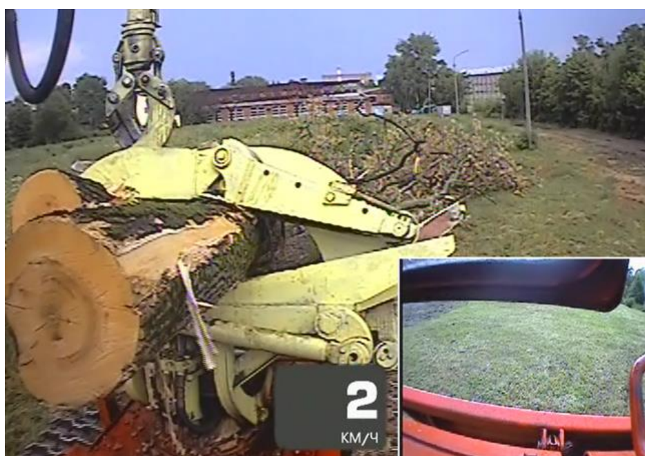
Рис. 3.9. Фрагменты проведения экспериментальных исследований на гусеничном трелевочном тракторе, полученные с измерительного комплекса Racelogic VBox
