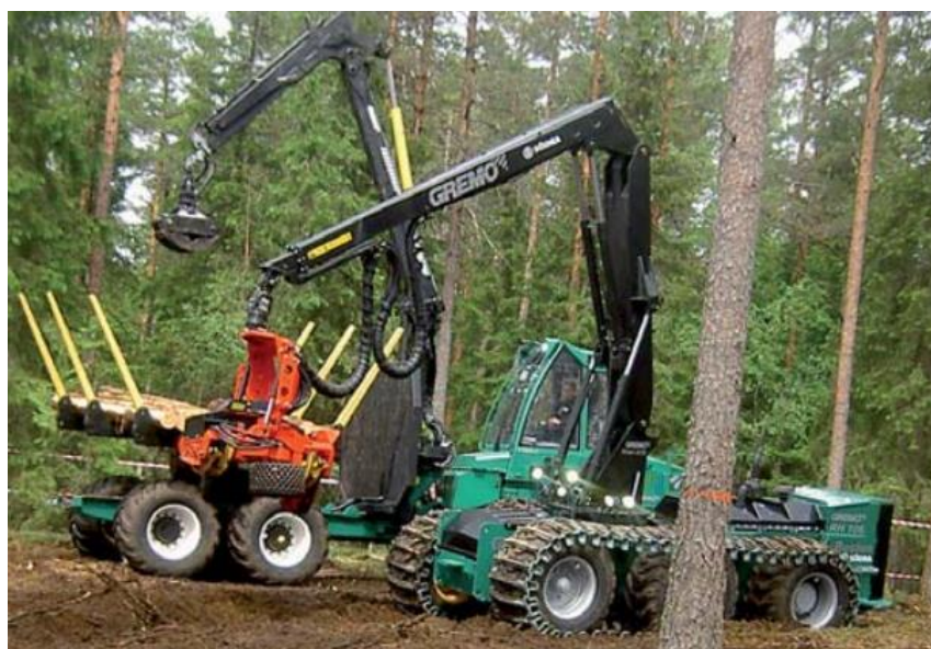
Рис. 1.23. Раскряжевка сортиментов радиоуправляемым харвестером Besten в кониковую площадку форвардера (машины сопровождения)
