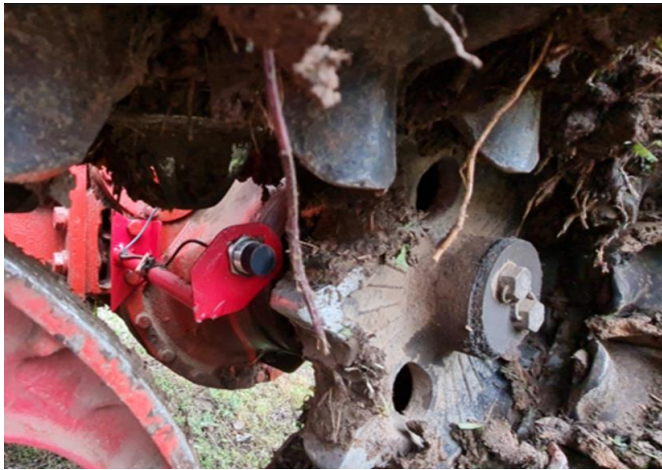
Рис. 3.7. Программно-измерительный комплекс определения угловой скорости вращения ведущих колес гусеничного трелевочного трактора
