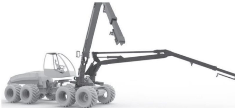
Рис. 1.24. Технология позволит одному оператору управлять несколькими манипуляторами одновременно, поскольку манипуляторы будут работать автономно в течение короткого времени
