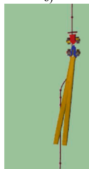
Рис. 6.47. Траектория движения СБПТМ и фрагменты моделирования: а - траектория движения колесной СБПТМ с пачкой деревьев 25 м; б – фрагмент моделирования движения колесной СБПТМ вид сзади; б – вид в плане
