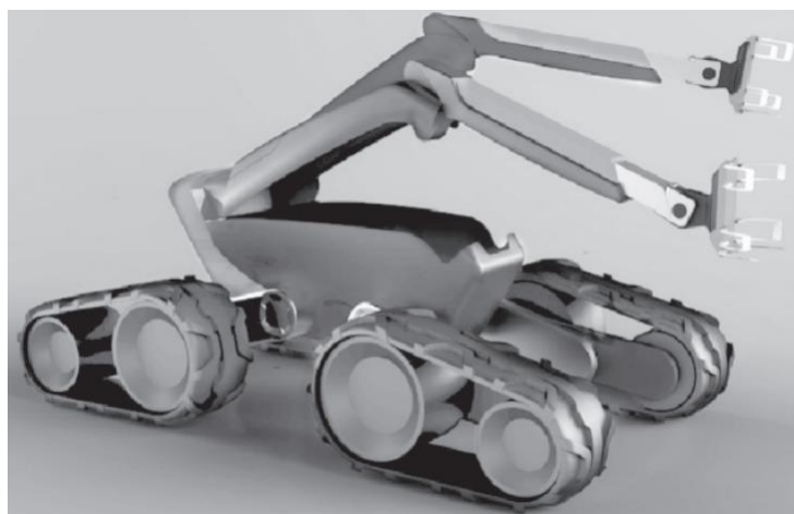
Рис. 1.25. Использование машин без оператора избавит от необходимости в установке кабины; автоматизация также может позволить нескольким манипуляторам работать на одной машине
