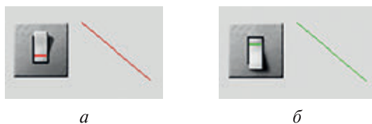
Рис. 2.4. Демонстрация работоспособности динамической привязки элемента «Выключатель 0» к элементу «Линия»
