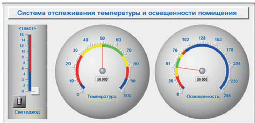
Рис. 8.4. Система отслеживания текущих показателей температуры и освещенности помещения
