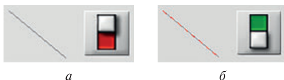
Рис. 2.6. Демонстрация работоспособности динамической привязки выключателя и контура линии
