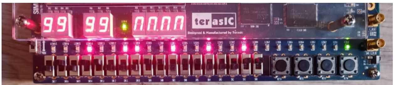
рис.10 Вид на HEX-индикаторы при переполнении задаваемых чисел
