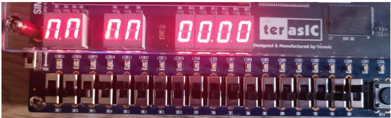
рис.9 Вид на HEX-индикаторы при переполнении задаваемых чисел
