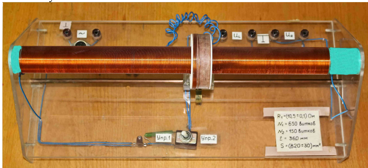
Рис. 4. Катушки с индуктивной связью.
