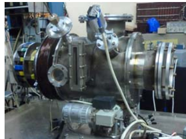
Рис.2. Схема и фото установки магнетронного разряда с полым катодом
