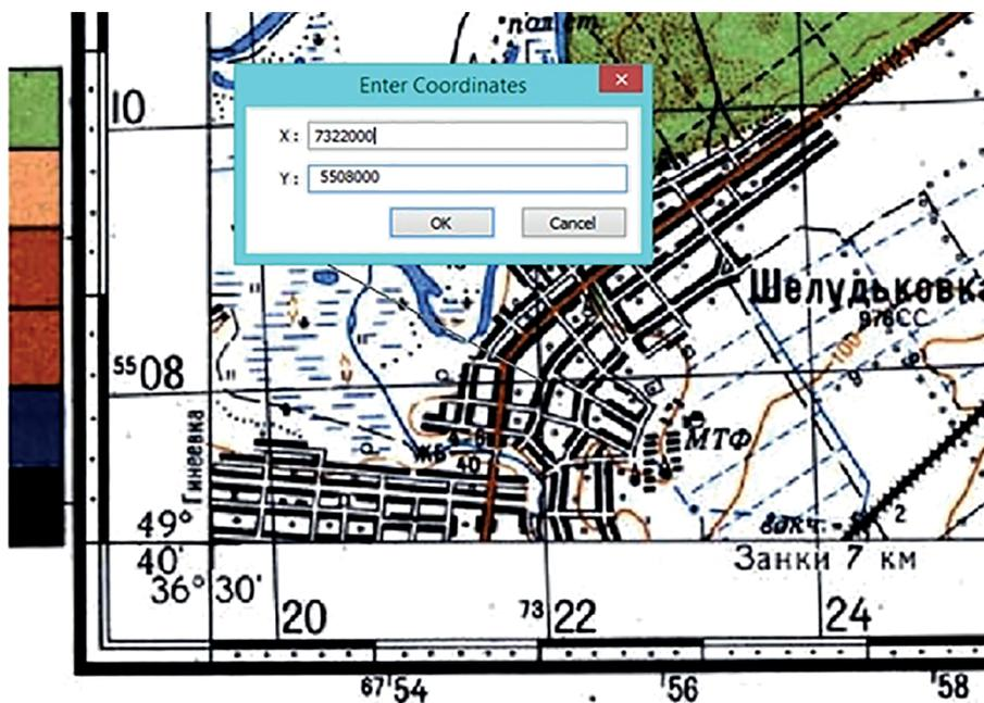
Рис. 2.12. Координаты контрольной точки, введенные в процессе привязки
