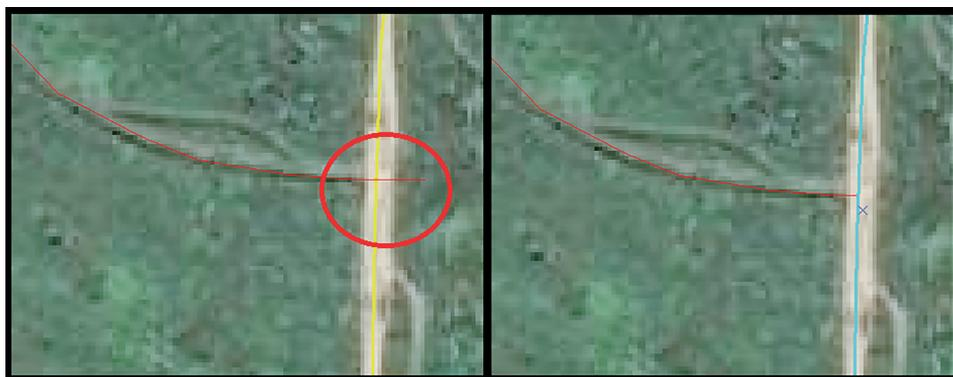
Рис. 5.10. Создание замыкающихся линейных объектов посредством функций Trim Extend
