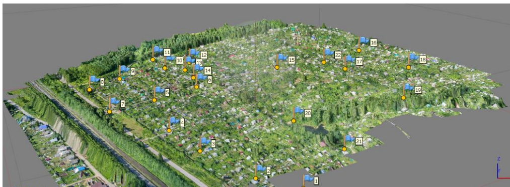
Рис. 8.15. Трехмерная модель рельефа, построенная по типу карты высот в 2,5D в режим отображения «текстурированный»
