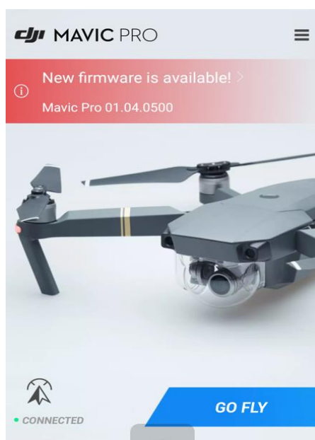
Рис. 6.6. Подключение смартфона как необходимого элемента управления к пульту Mavic Pro
