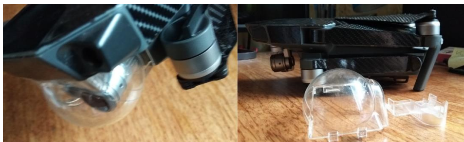
Рис. 6.2 Снятие защиты камеры в процессе подготовки модели к использованию
