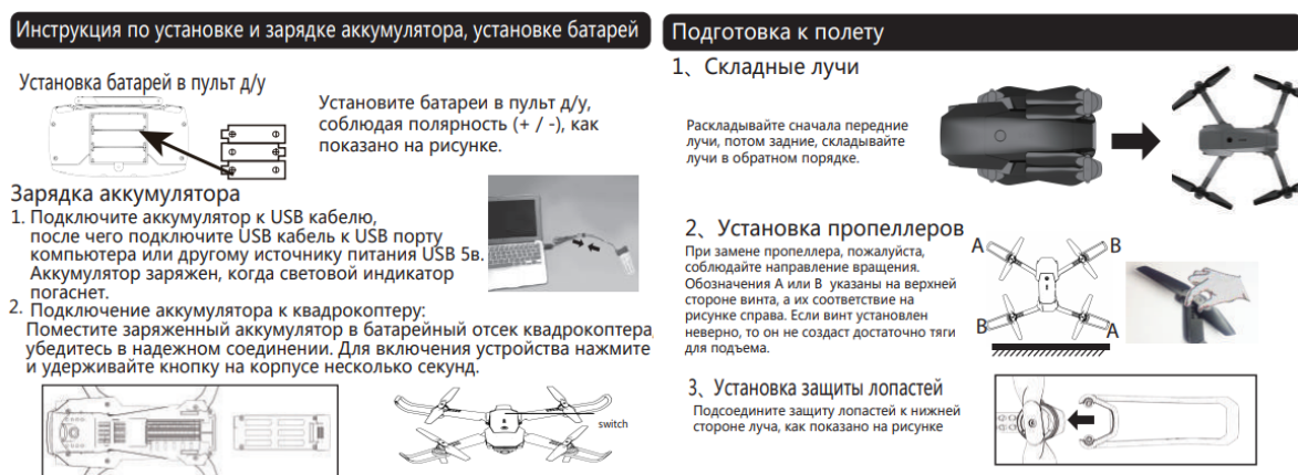
Рис. 3.2. Установка аккумулятора и подготовке модели работе.
