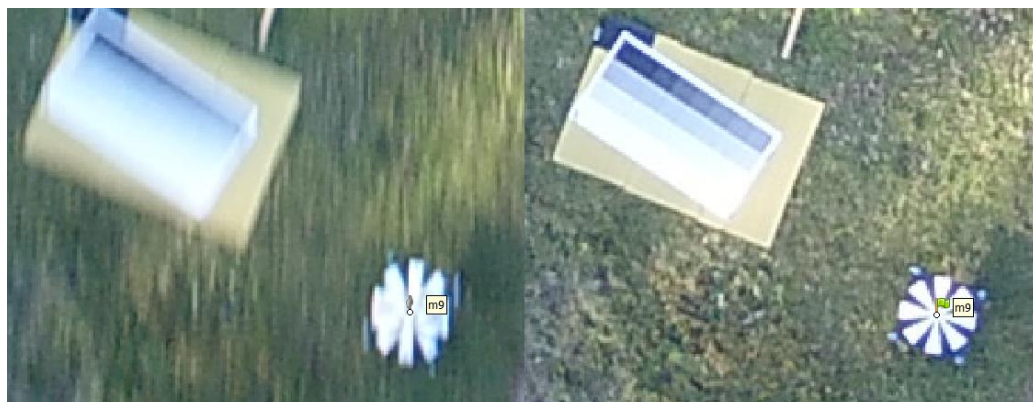
Рис. 6.9. Бракованный снимок и удовлетворительный снимок элементов ИНК
