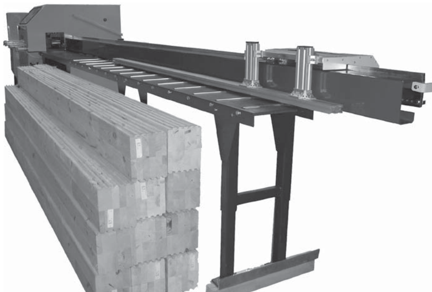
Рис. 8 - Пример использования системы ЕХАКТ NC совместно с чашкорезным станком
