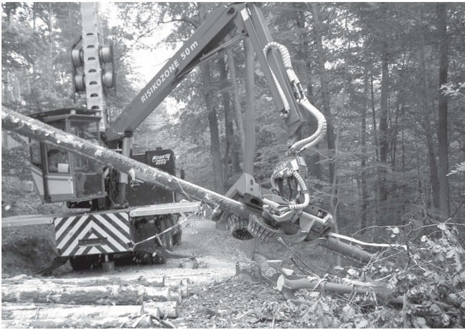
Рис. 3. Очистка дерева от сучьев и раскряжевка хлыста на сортименты
