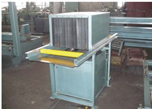
Установка антисептирования КОС-15
