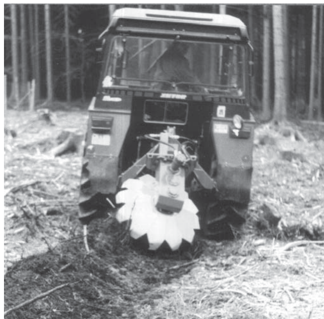
Однодисковый рыхлитель TPF-1N с приводом от сельскохозяйственного трактора
