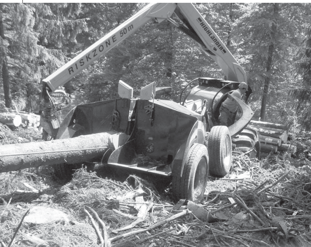
Трелевочная тележка внизу спуска у харвестера "Хайлендер". Хорошо виден щит с комлем дерева и лебедка с тросом тележки.
