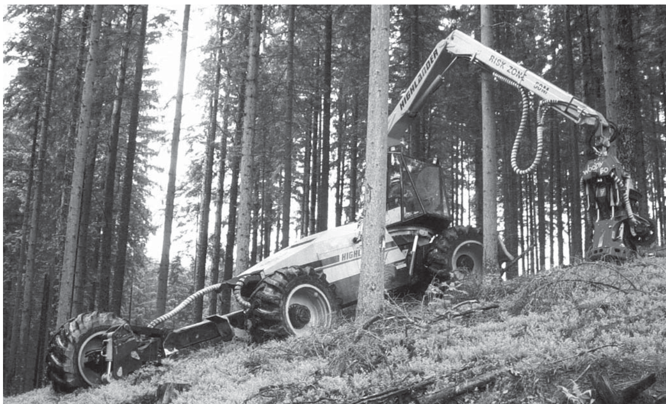
Харвестер "Хайлендер". Видна стрела харвестера с головкой "Вуди Н60" на валке деревьев (Фото KONRAD Forsttechnik GmbH)
