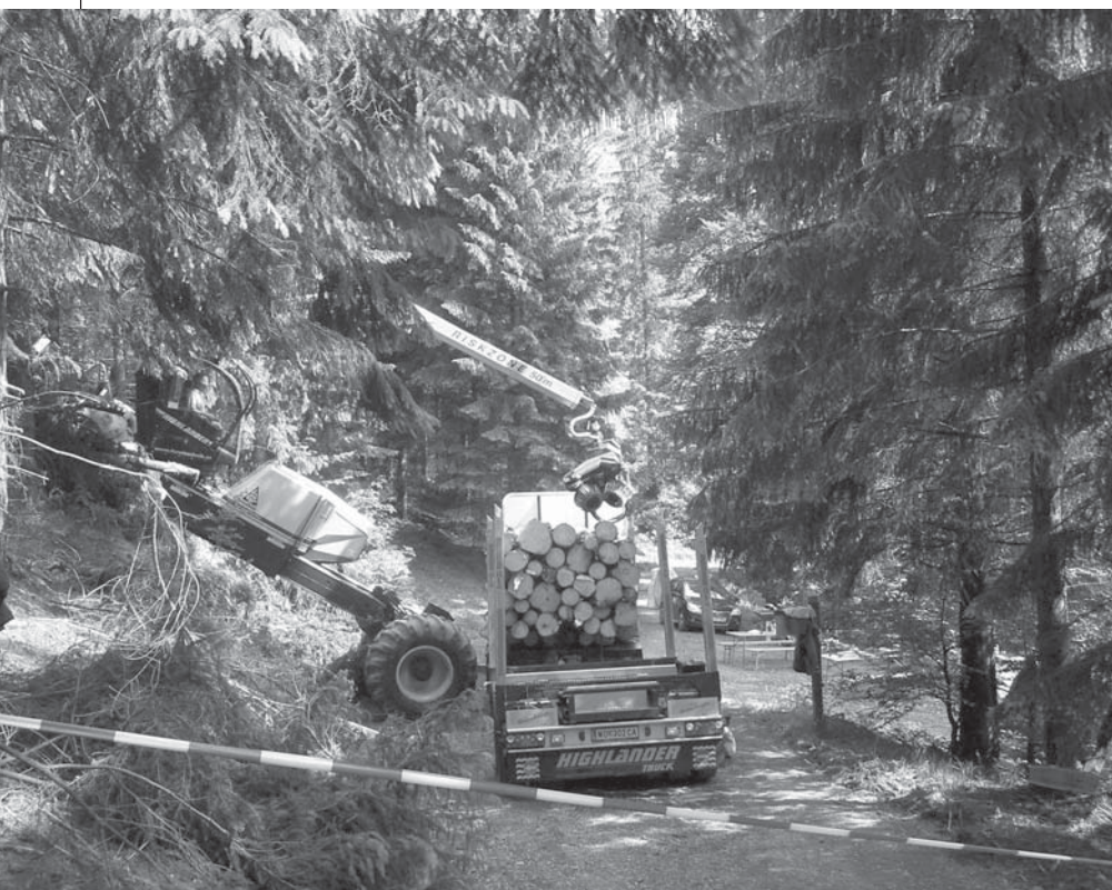
Харвестер "Хайлендер". Видна стрела харвестера с головкой "Вуди Н60" на погрузке сортиментов в сортиментовоз
