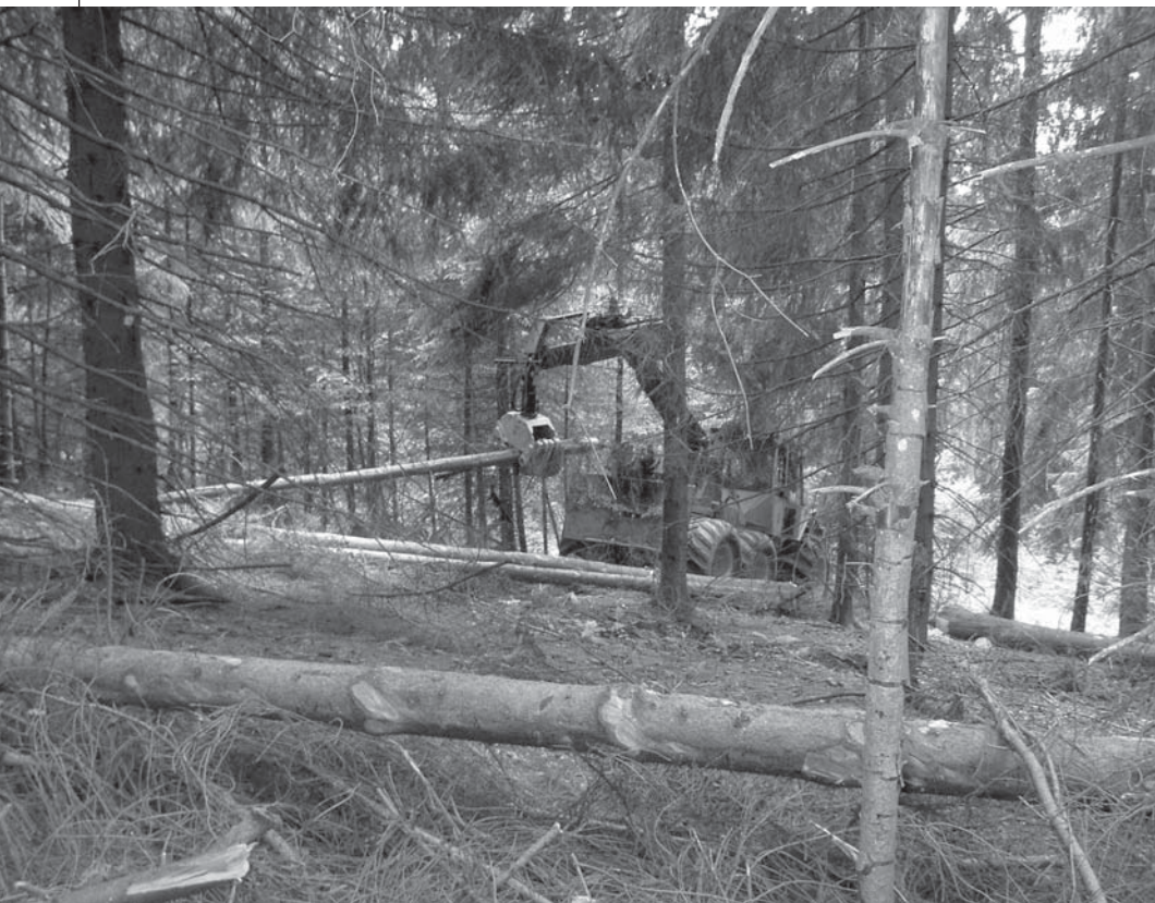
Трелевочный трактор собирает хлысты (полухлысты) в пачку
