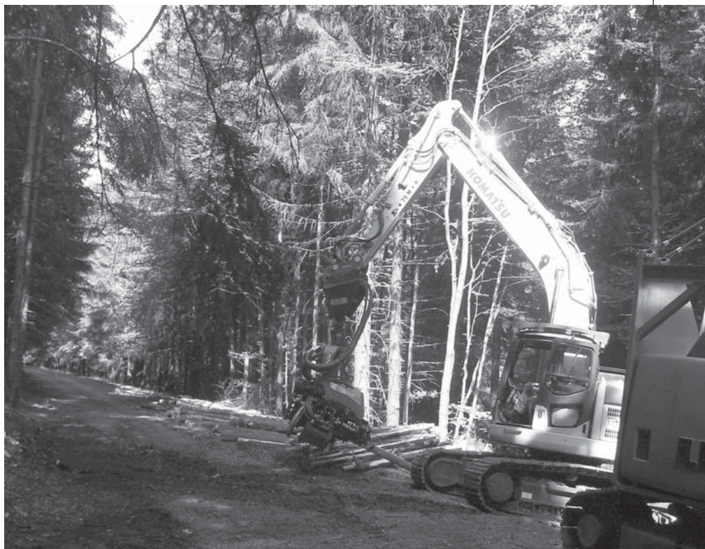
Очистка доставленных канатной установкой деревьев от сучьев и раскряжевка хлыстов на сортименты с использованием сменной харвестерной головки, смонтированной на гусеничном экскаваторе
