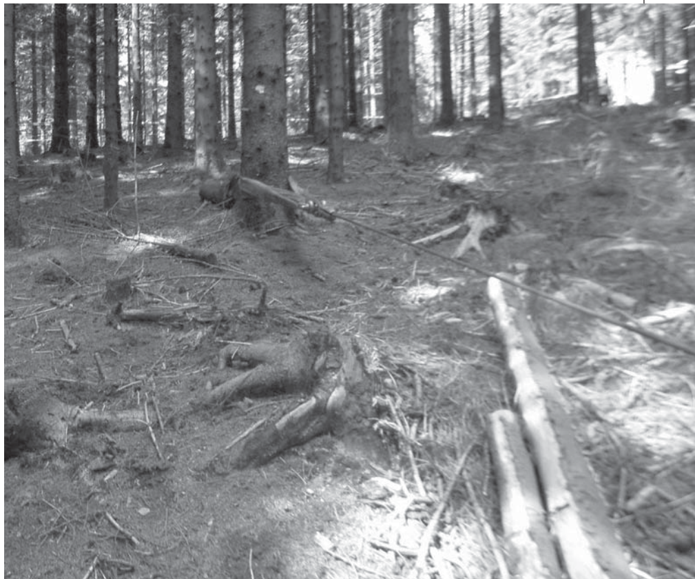
Крепление страхующего троса за "якорное" дерево
