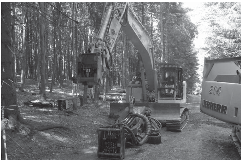
Смена рабочего органа - харвестерной головки на гидравлический захват. Харвестерная головка просто отсоединяется из кабины оператора
