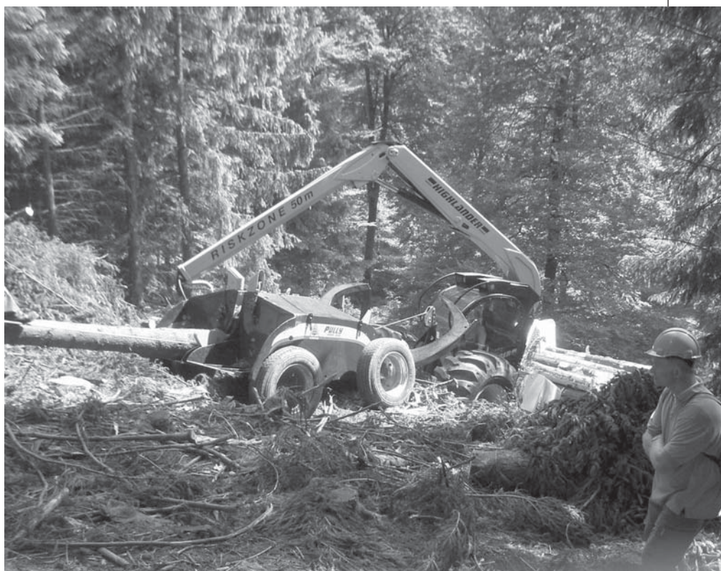
Трелевочная тележка внизу спуска у харвестера "Хайлендер". Видна стрела харвестера с головкой "Вуди Н60"
