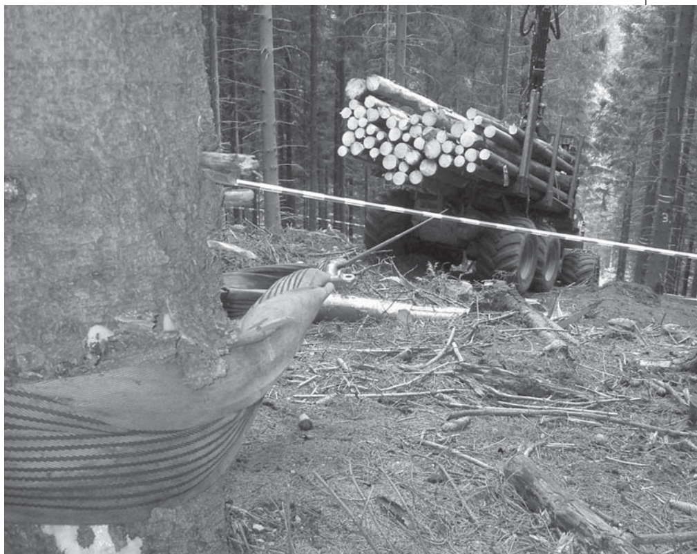
Форвардер Forcar FC200 спускается по склону с пачкой сортиментов. Спуск контролируется задней лебедкой с пропорциональным контролем скорости сматывания троса, который закреплен за "якорное" дерево
