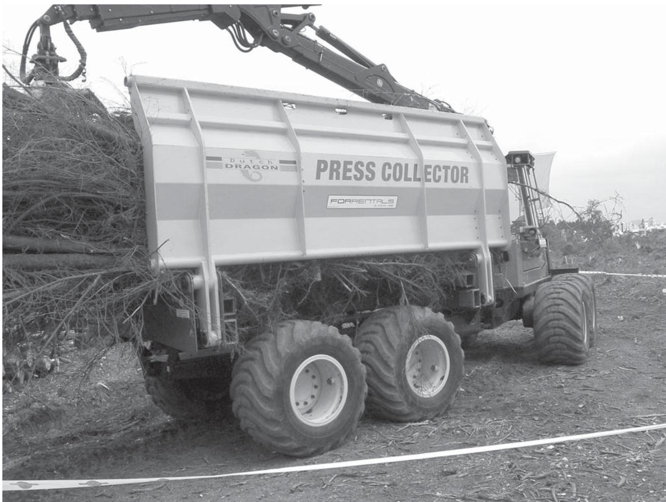
Транспортная машина со специальным уплотняющим кузовом датской фирмы DRAGON
