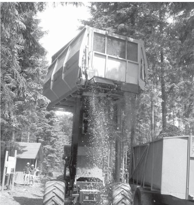
Последовательность перегрузки щепы из бункера в съемный контейнер (1 - 5)
