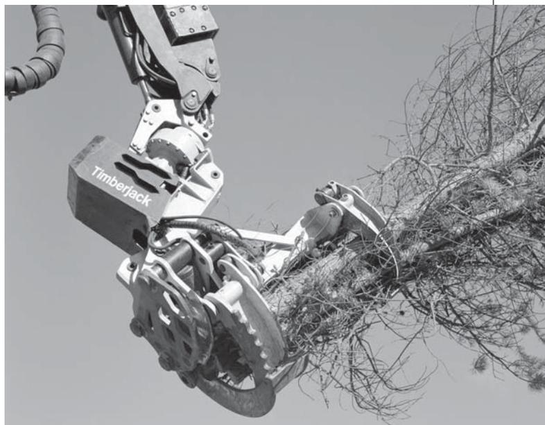
Аккумулярирующая головка компании Timberjack (фото компании Timberjack )
