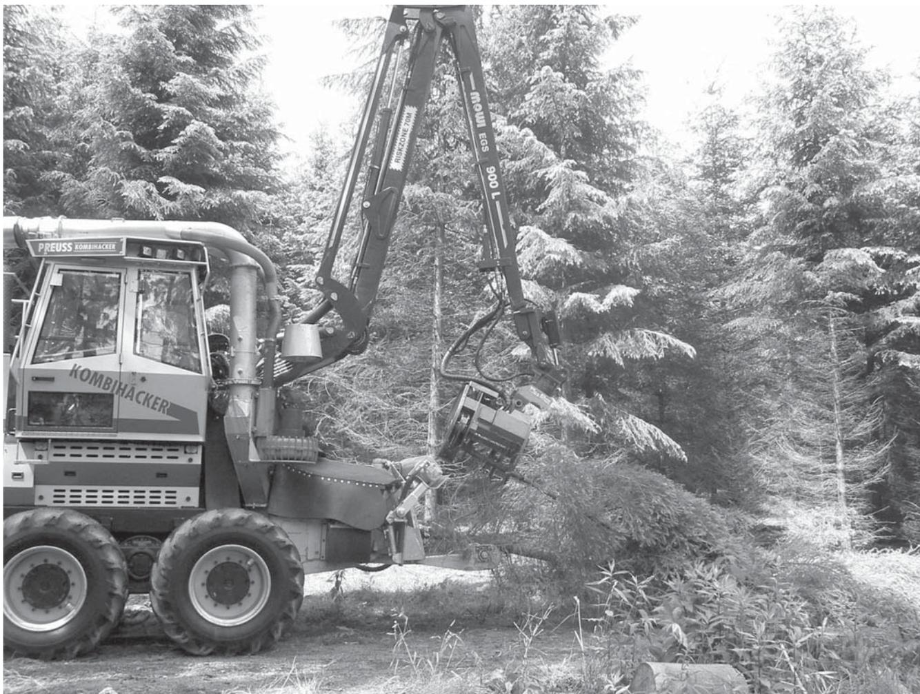
**Лесной комбайн для производств топливной щепы немецкой компании Preuss Forstmaschinen**
