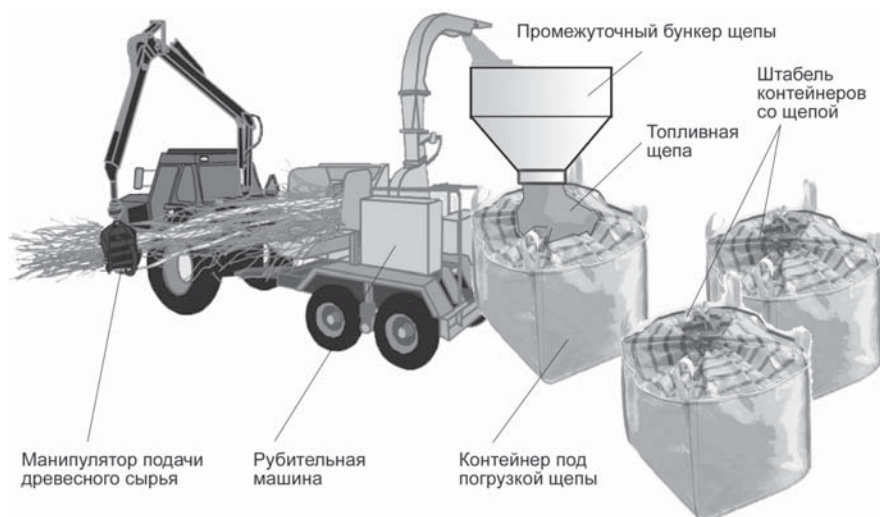
Рис. 3. Узел переработки древесной массы на топливную щепу и загрузки ее в контейнеры через промежуточный бункер
