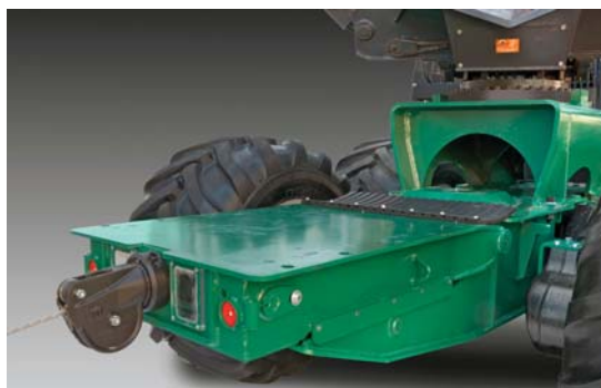
Рис. 8. Форвардер Greemo 1350 VT оснащен мощной лебедкой и гидравлически управляемым поворотным приемным столом
