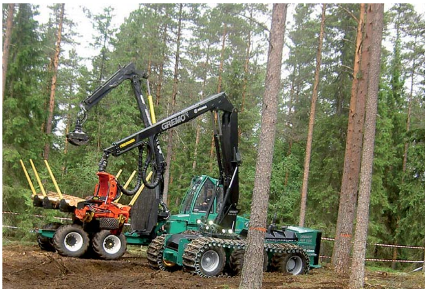
Рис. 5. Работа харвестера «Besten» с форвардером сопровождения
