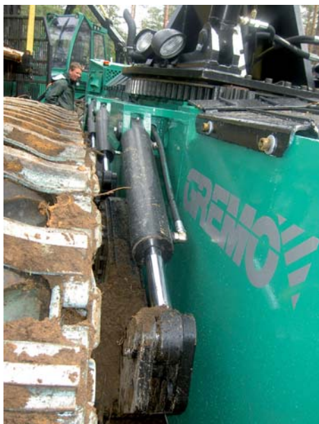
Рис. 2. Шесть колес установленных на маятниковых рычагах
