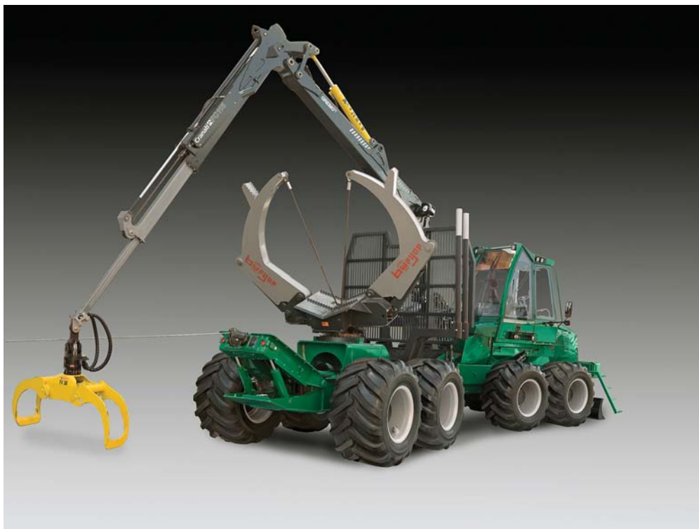
Рис. 7. Форвардер Greemo 1350 VT оснащен гидравлическим пачковым захватом, что позволяет использовать его на трелевке хлыстов
