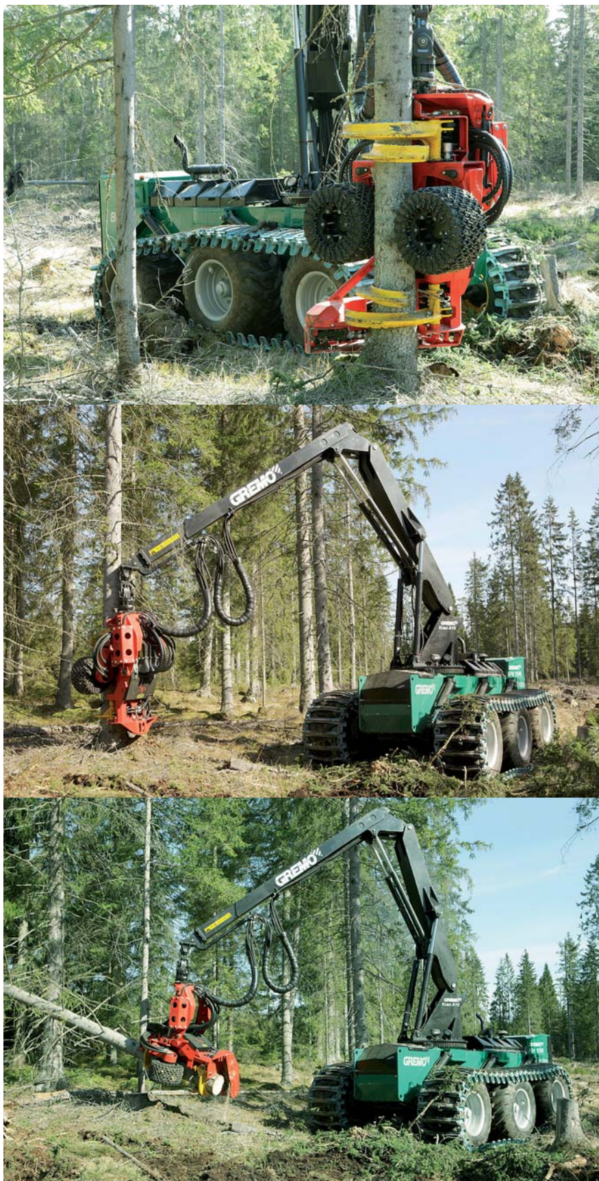
Рис. 4. Последовательность лесозаготовок с использованием харвестера «Besten»
