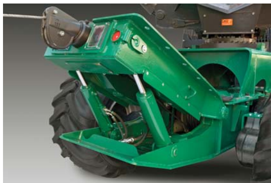
Рис. 7. Форвардер Greemo 1350 VT оснащен гидравлическим пачковым захватом, что позволяет использовать его на трелевке хлыстов
