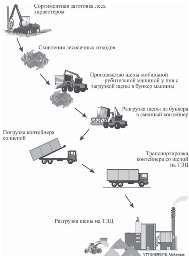
Рис. 1. Технология производства щепы на лесосеке с использованием мобильной рубительной машины с бункером для щепы
