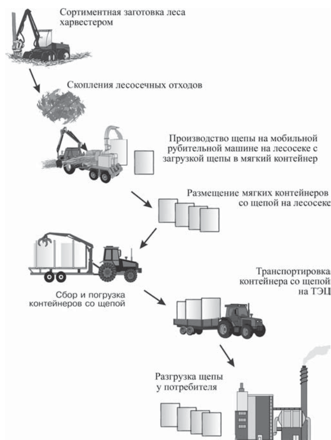
Рис. 2. Технология производства щепы на лесосеке с использованием мобильной рубительной машины с мягкими контейнерами для щепы
