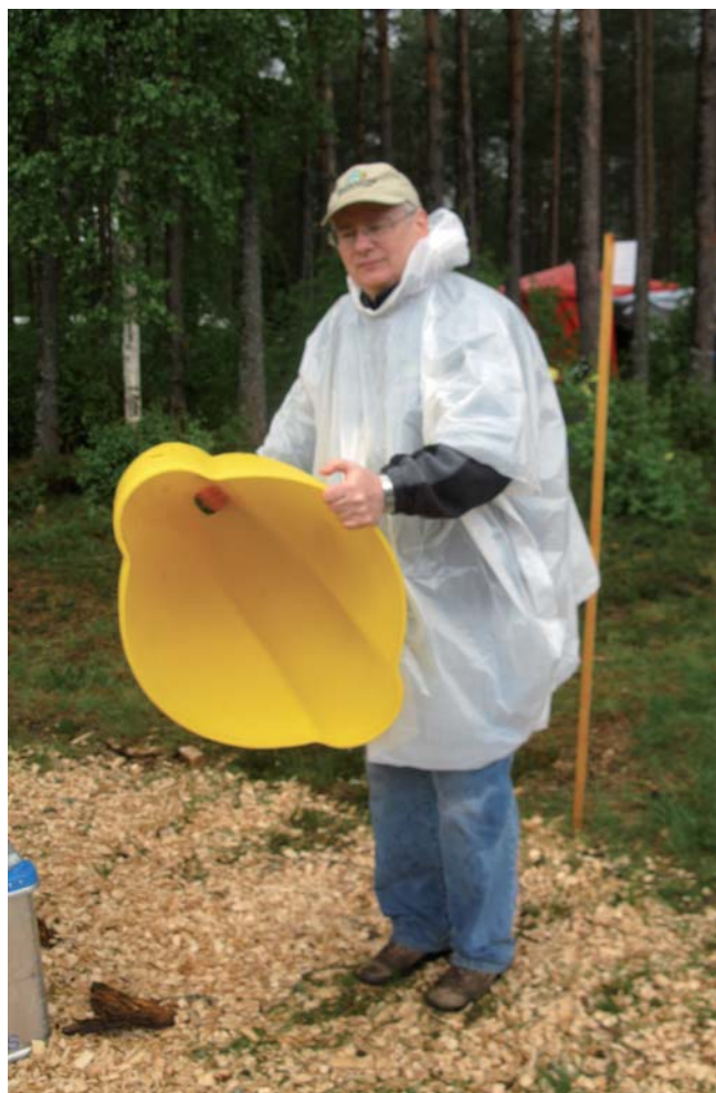
Современные конусы для трелевки древесины изготовлены из пластика, легкие и прочные (на выставке SkogsElmia 2011 в Швеции)
