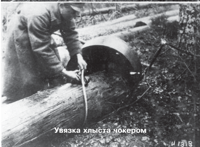
Приспособление для прицепки чокеров к тяговому тросу (конструкция ЦНИИМЭ 30г.г.)
