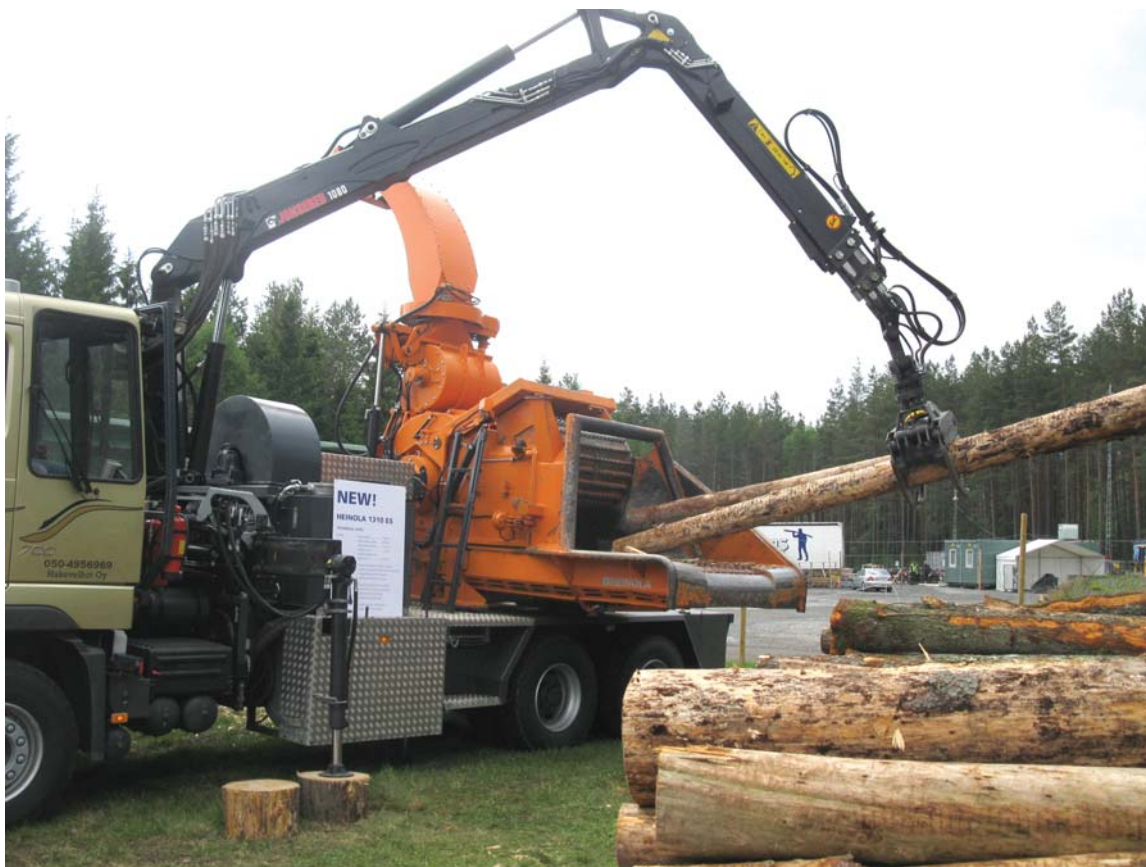
Рис. 3. Подача бревен манипулятором из штабеля в окно рубильной машины
