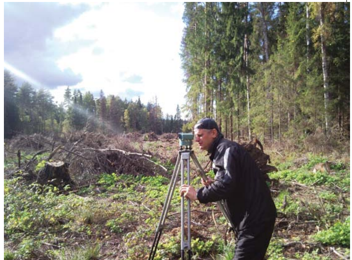
Рис. 2. В полевых условиях участок разбивали по правилам геодезии с использованием металлической мерной ленты, вешек и нивелира
