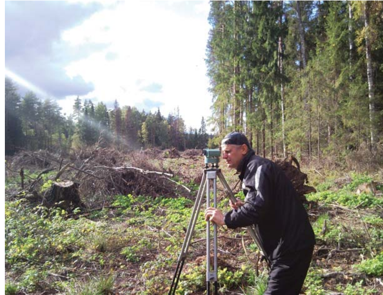
Рис. 4. В полевых условиях участок разбивали по правилам геодезии с использованием металлической мерной ленты, вешек и нивелира
