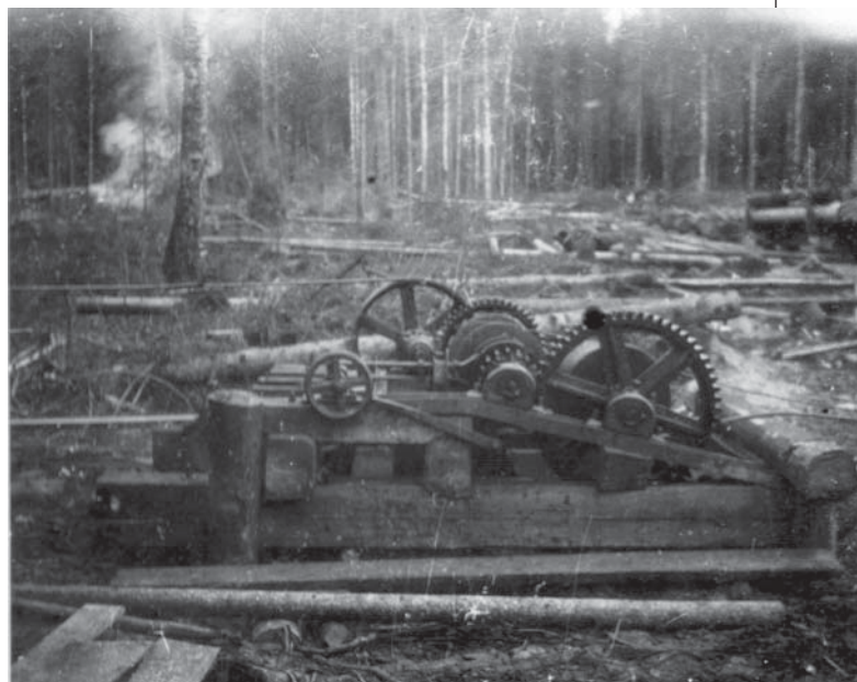
Рис. 5. Общий вид 2-х барабанной лебедки конструкции Мослеспром
