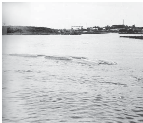
Рис.6. Плот из мягких плавучих контейнеров
