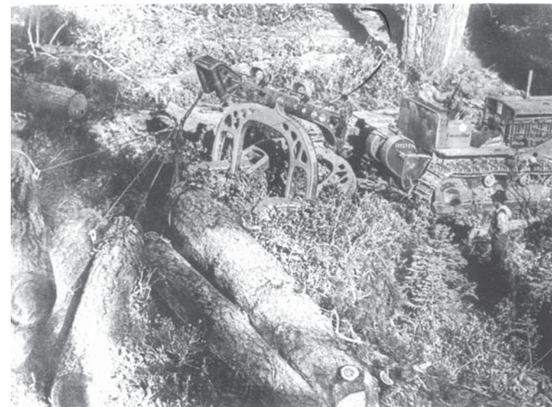
Рис.13. Подтаскивания лесоматериалов расположенных под углом к арке в захламленной лесосеке
