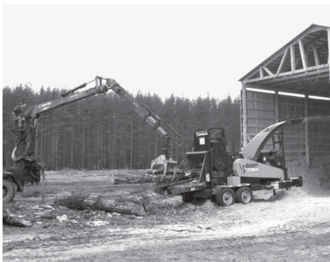
Рис. 4 Рубительная машина Bandit на прицепной тележке с автономным двигателем (а) и машина Heinola с дисковым рабочим органом на полуприцепе (б)
