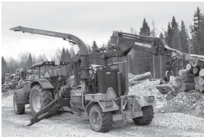
Рис. 3 Рубительные машины на пневмошасси с приводом от ВОМ трактора: Kesla (а) и УРП-1 с дисковым рабочим органом (б)
