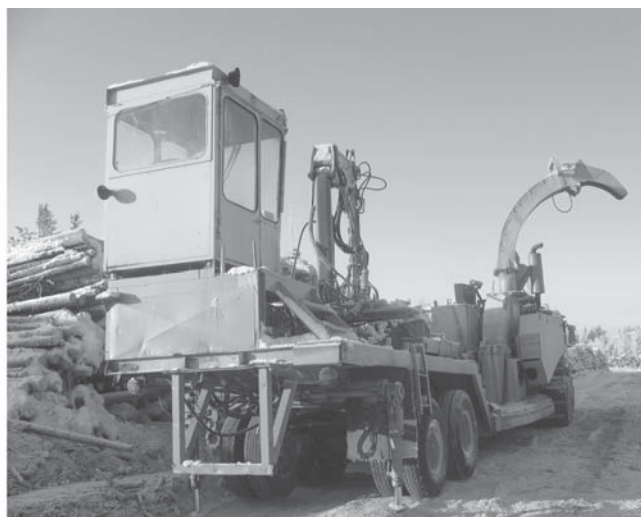
Рис. 4 Рубительная машина Bandit на прицепной тележке с автономным двигателем (а) и машина Heinola с дисковым рабочим органом на полуприцепе (б)
