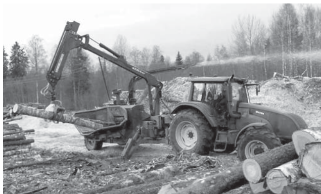
Рис. 6. Рубительная машина Kesla 4560С во время работы
