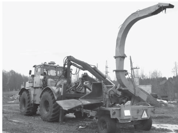
Рис. 3 Рубительные машины на пневмошасси с приводом от ВОМ трактора: Kesla (а) и УРП-1 с дисковым рабочим органом (б)
