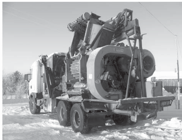
Рис. 5 Рубительные машины Heipola на шасси автомобиля: с автономным двигателем (а) и с приводом от двигателя автомобиля (б)
