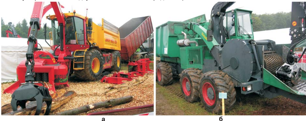
Рис. 8. Самоходные рубильные машины с накопительными бункерами и фронтальной подачей сырья: а) Vredo VT3936; б) Meindl
