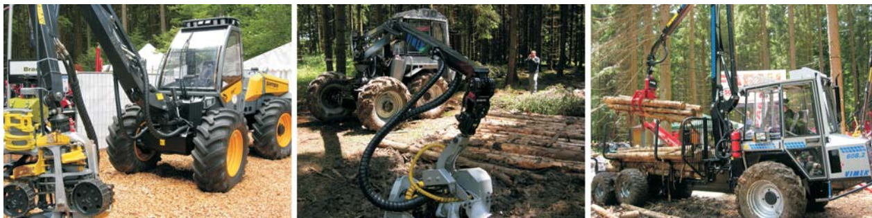
Рис. 15. Машины для рубок ухода: а) харвестер 4x4 Sampo SR 1046pro; б) харвестер 4x4 Vimek 404T4; в) форвардер 6x6 Vimek 608.2
