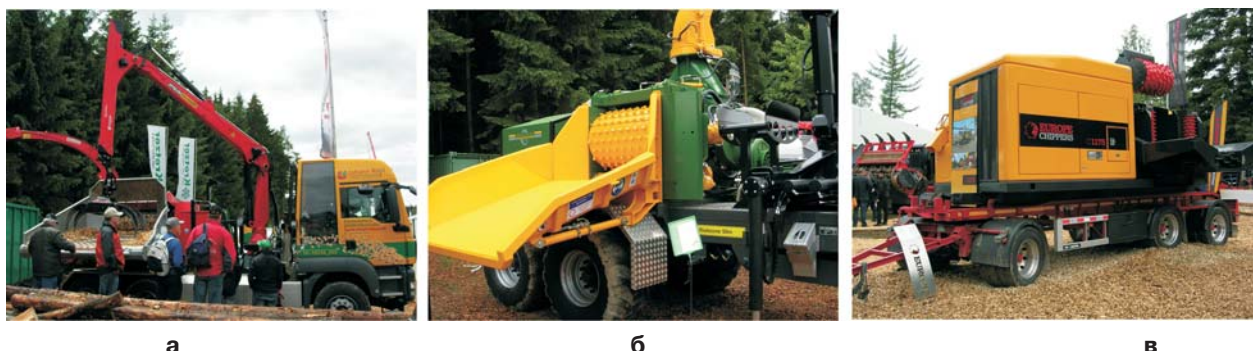
Рис. 3. Мобильные барабанные рубильные машины: а) на базе автомобиля фирмы Mus-max; б) на двухосном полуприцепе фирмы Dutch Dragon; в) на трехосном прицепе фирмы Europe Forestry
