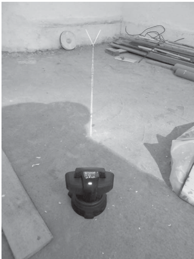
Нивелир в работе. Линии лазерных лучей сведены в одну
