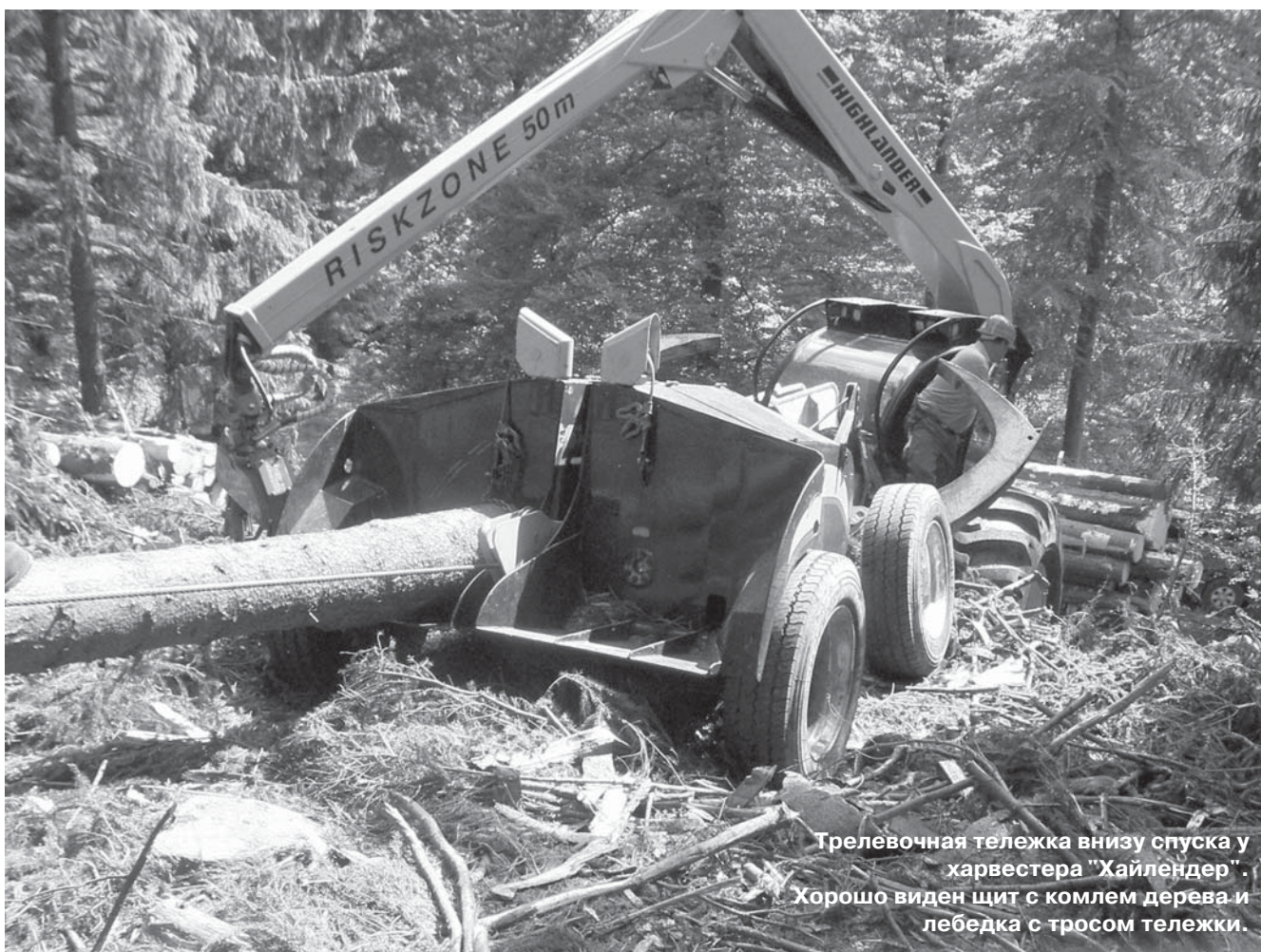
Трелевочная тележка внизу спуска у харвестера "Хайлендер". Видна стрела харвестера с головкой "Вуди Н60".
