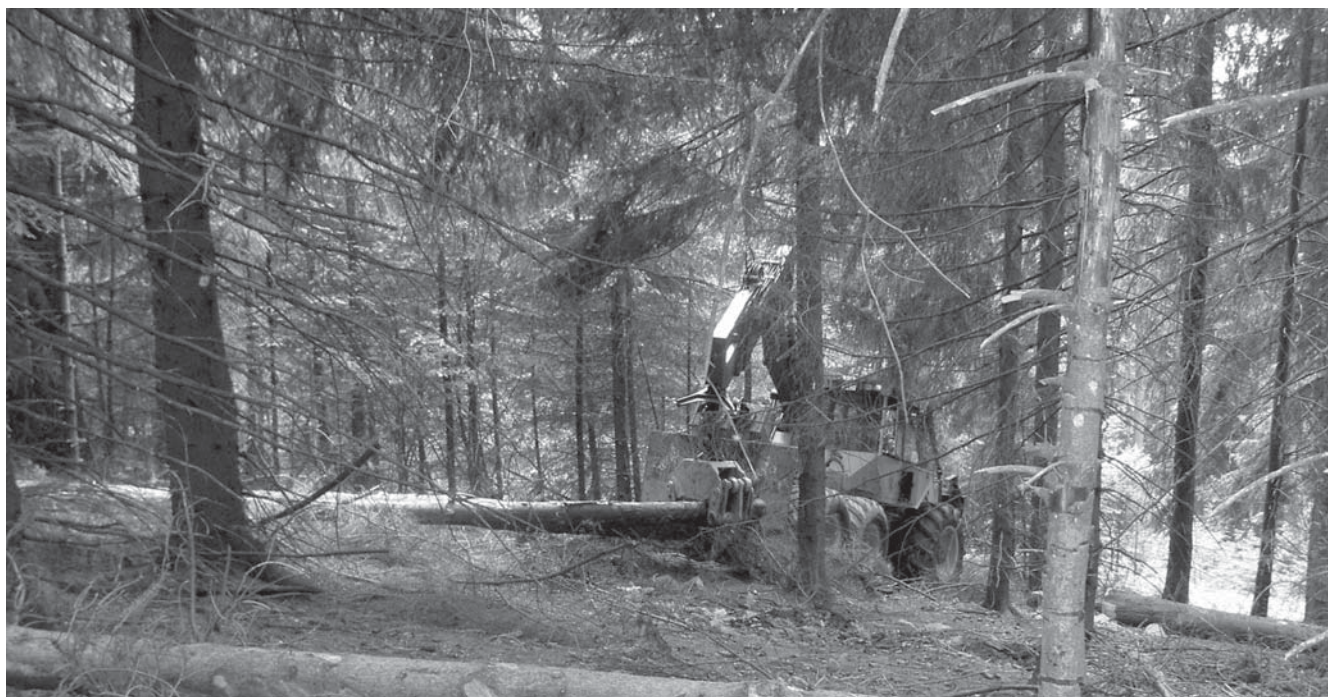
Трелевка пачки хлыстов (полухлыстов) к погрузочному пункту у лесной дороги
