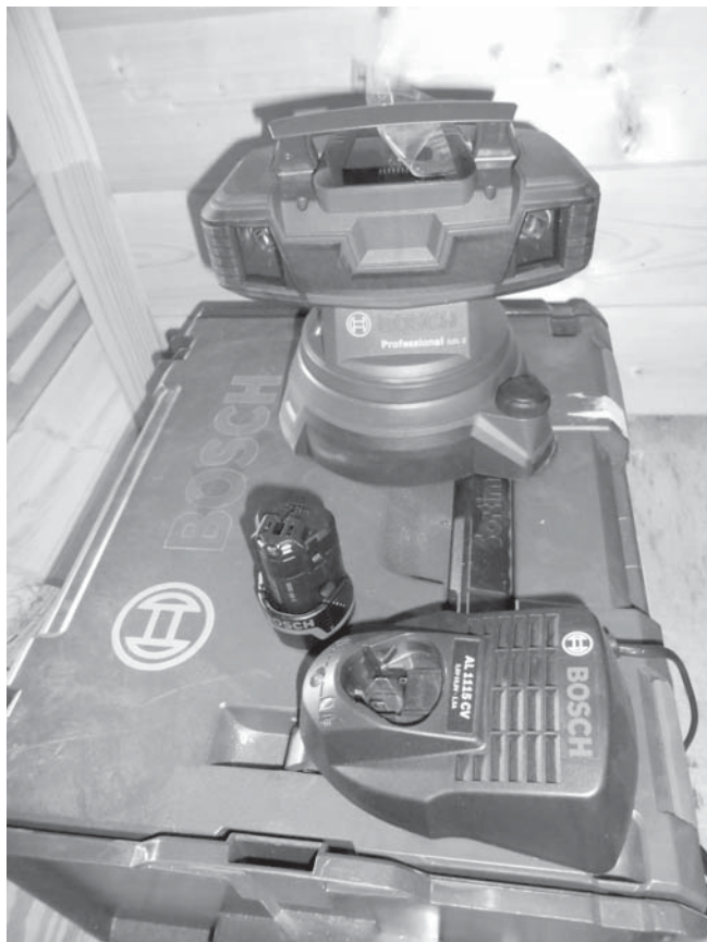
Поверхностный лазерный нивелир GSL 2 с аккумулятором и зарядным устройством
