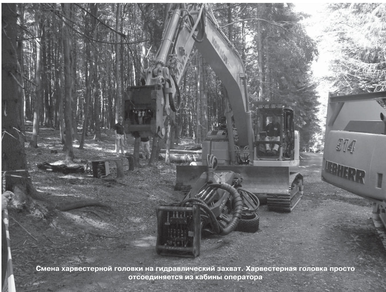
Очистка доставленных канатной установкой деревьев от сучьев и раскряжевка хлыстов на сортименты с использованием сменной харвестерной головки, смонтированной на гусеничном экскаваторе
