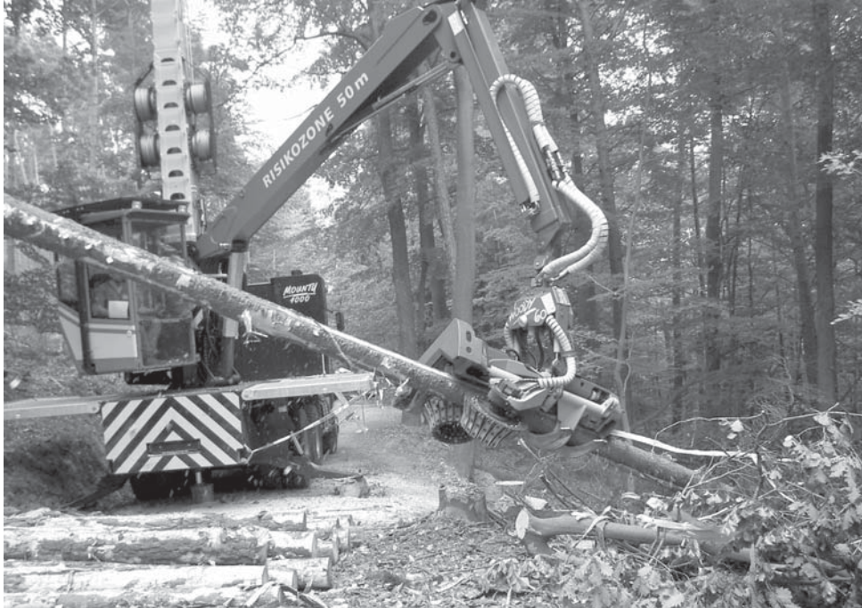
Рис. 2. Очистка дерева от сучьев и раскряжевка хлыста на сортименты
