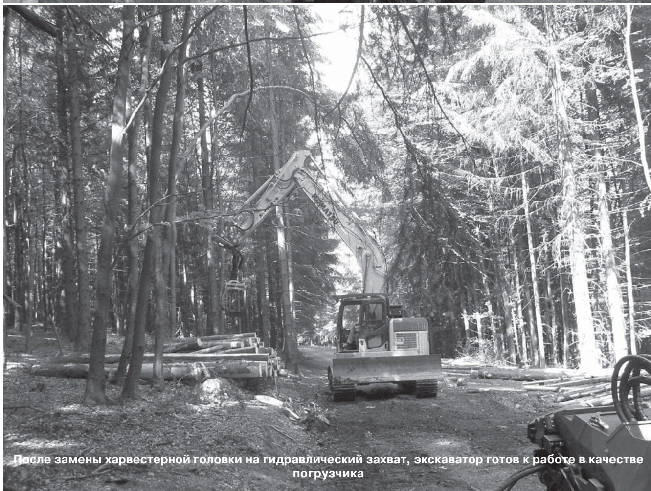
Смена харвестерной головки на гидравлический захват. Гидравлический захват устанавливается на место харвестерной головки из кабины оператора
