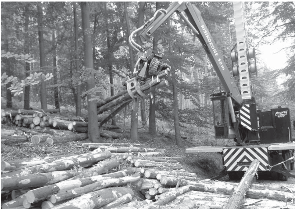
Рис. 3. Укладка пачки сортиментов в придорожные штабеля
