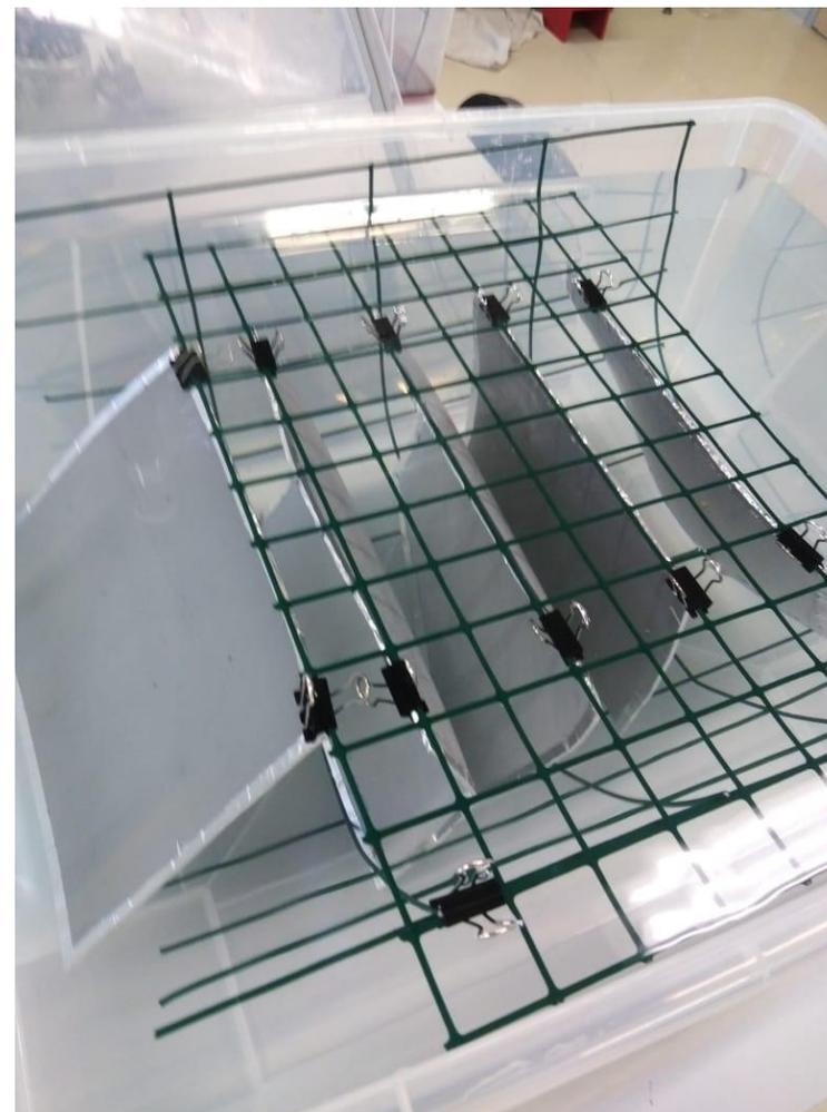
Студенты принимали участие в проектировании и изготовлении оснастки для проведения испытаний на прочность сцепления при сдвиге
