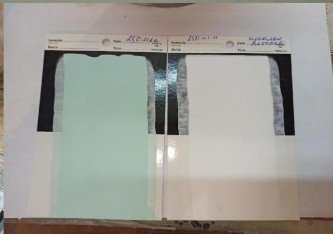
Определение укрывистости высушенной пленки с помощью карточки Leneta
