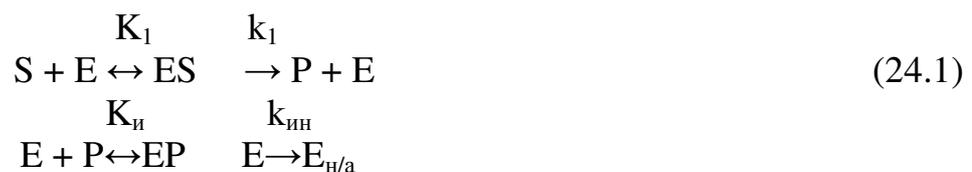
где:  $K_{ин}$  – константа ингибирования фермента продуктами гидролиза,  $[EP]$  – концентрация неактивного комплекса фермента с продуктами гидролиза. Остальные обозначения соответствуют аналогичным обозначениям в схемах (24.1) и (24.2).
