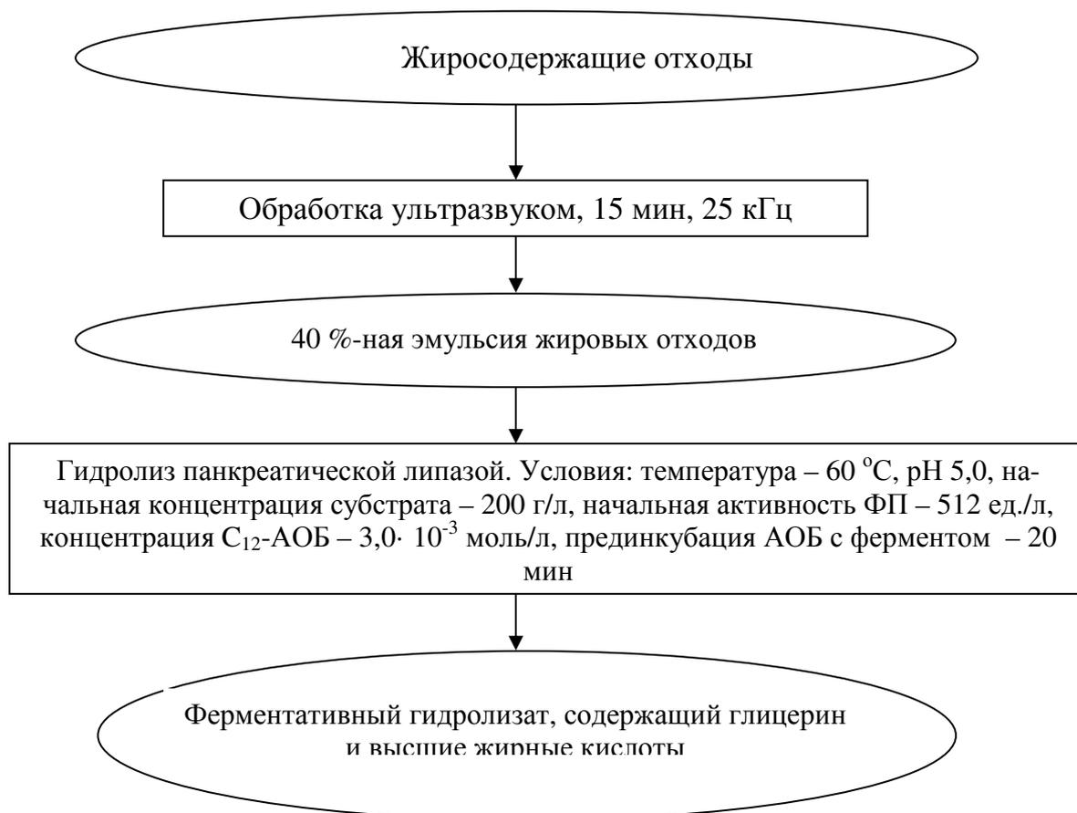
Рис. 15.3. Принципиальная схема получения панкреатического гидролизата на основе жировых отходов
