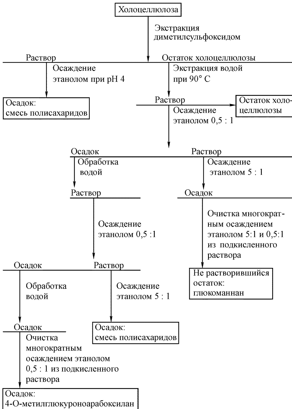
Рисунок 105. Схема выделения гемицеллюлоз древесины кедра при экстракции диметилсульфоксидом и водой
