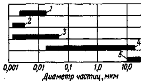
Рис. 1.7. Различные способы фильтрования в зависимости от размеров частиц: 1 – мембранная фильтрация, 2 – электродиализ, 3 – диализ, 4 – микрофильтрация, 5 – обычное фильтрование
