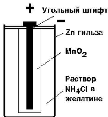
Рис. 9.5. Химический элемент – источник постоянного тока 1,5 В
