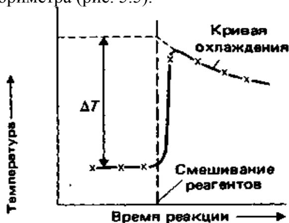
Рис. 5.5. Чтобы получить точное значение  $\Delta T$ , строят график зависимости температуры от времени, измеряя температуру каждые 30 с. Затем экстраполируют кривую охлаждения калориметра к точке, отвечающей моменту начала реакции (0 секунд)
