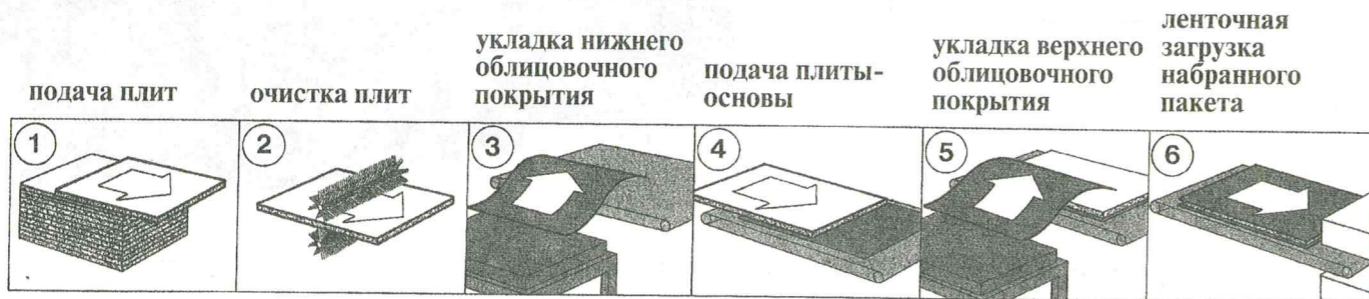
Схема короткотактного ламинирования
