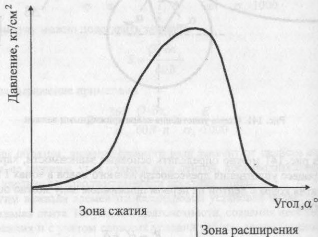
Рис. 142. Усилия прессования прижимными валами
