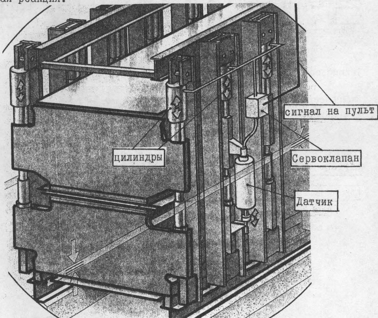
Возможность регулирования толщины брикета вдоль прессы показана на рис. Уплотнение брикета (мм/м) от давления плит прессы составляет определенное значение. Отклонение плит прессы вызывает также определенные значения декомпрессии. Постоянные значения компрессии и декомпрессии в сочетании с удельным давлением на брикет вызывает постоянство толщины древесной плиты.
