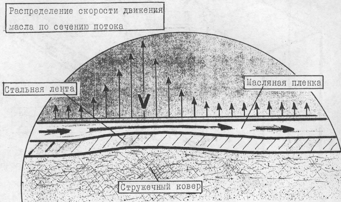
Регулирование давления масла в зазоре для смазки.
