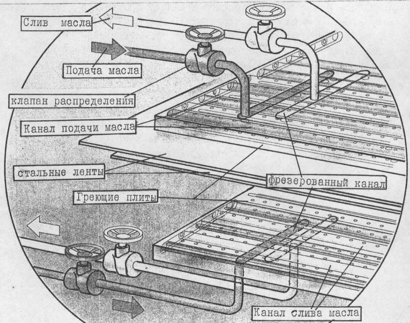
В этом прессе нагревательная плита наряду с передачей усилия прессования служит также в качестве системы распределения масла, которое выходит из греющей плиты через множество каналов-форсунок и оттуда попадает в масляную пленку. Одновременно греющая плита заключает в себе в непосредственной близости к подводу масла систему отвода. Отверстия в греющей плите чередуются на подводящие и отводящие.
