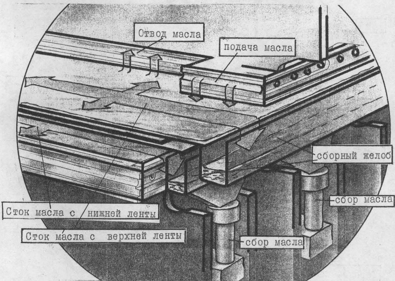
Система герметизации в прессе следит за тем, чтобы по возможности ни одна капля силиконового масла не уходила бесконтрольно из системы.
