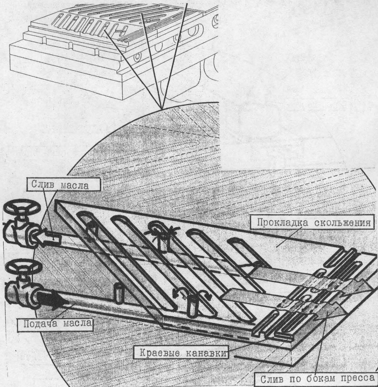
Отклоняясь от пути отвода, задаваемого давлением рециркуляции, масло частично течет через края поверхности скольжения. Этому потоку препятствуют уплотнительные канавки и снижают его до минимума. Масло попадает в сборные желоба и направляется в систему рециркуляции.
