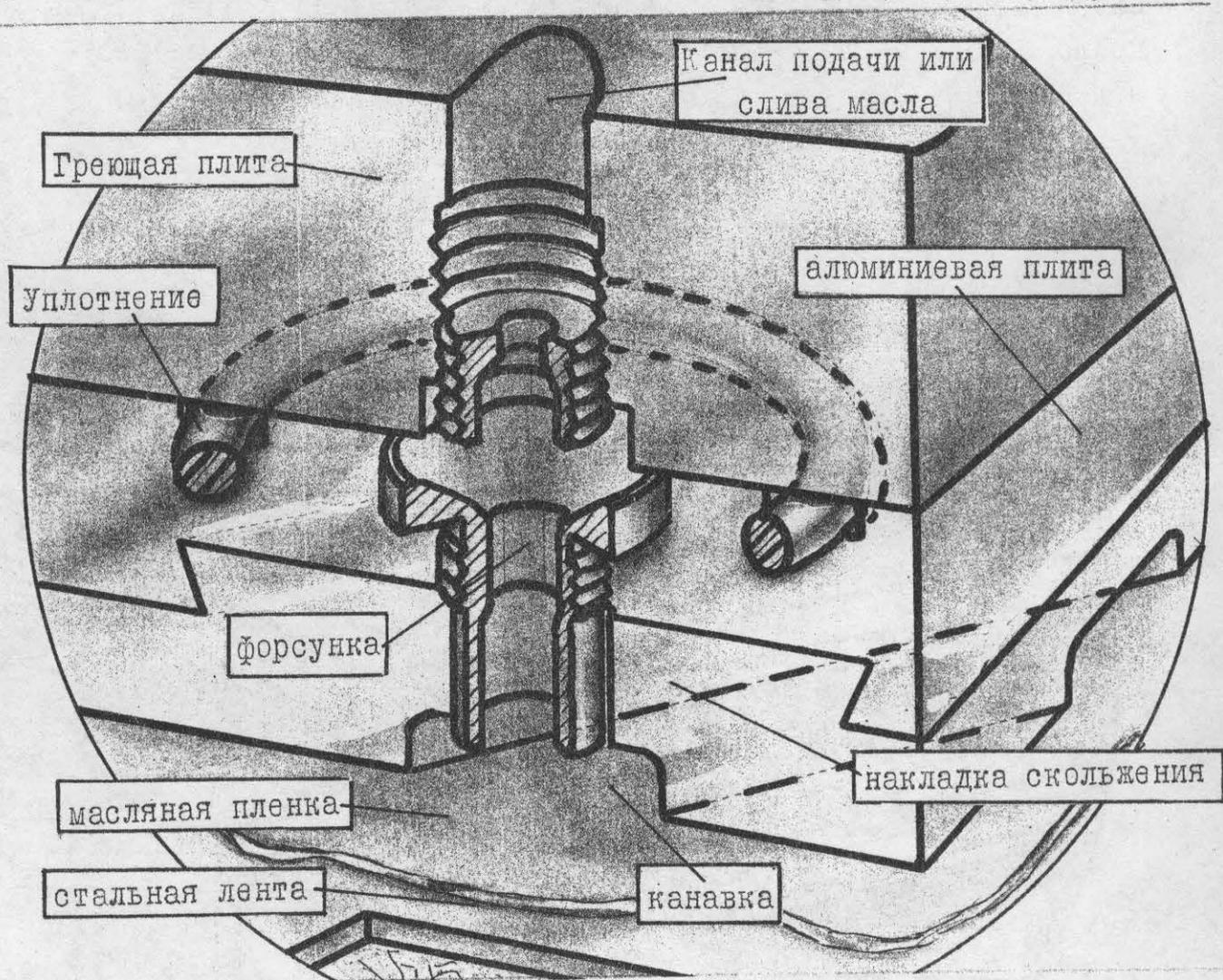
Аналогично изображению подачи масла на рисунке показан ход потока сбора или слива силиконового масла, вытекающего из пленки скольжения. Важно отметить, что распределительным клапаном в трубопроводе рециркуляции масла можно регулировать противодавление, т.е. можно оказывать влияние на количество вытекающего масла и, соответственно, на количество масла остающегося в зазоре.
