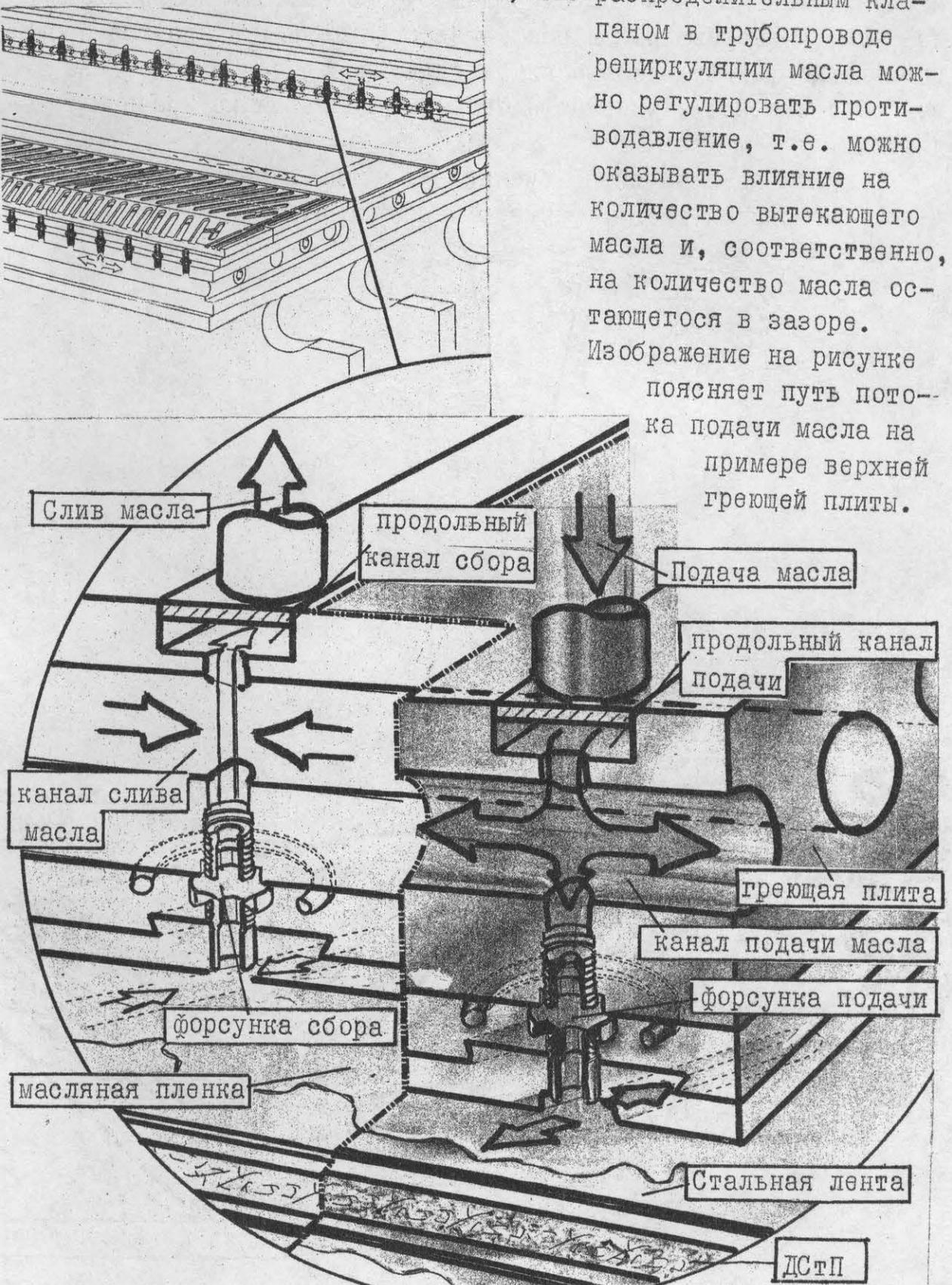
На обеих продольных сторонах пресса высокое давление в зазоре для смазки непосредственно противодействует давлению окружающей среды. Этот перепад давления придает силиконовому маслу тенденцию слива по сторонам. Через систему лабиринта канавок, фрезерованных в накладках скольжения, создается сопротивление выходу масла сбоку. Продольное расположение канавок обеспечивает ступенчатое снижение давления на краевом участке.
