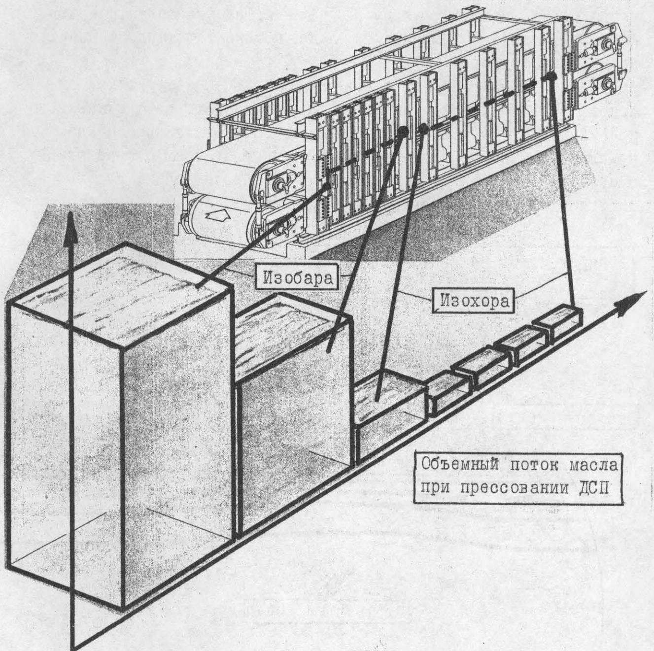
Для получения продукции строгих размеров по толщине необходимо добиваться наиболее однородной насыпки прессуемого материала. Однако неравномерность поступления прессуемого материала, как правило, неизбежна. При возможных колебаниях в насыпке возникают зоны взаимодействия, показанные на рисунке.
