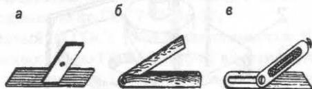
Рис. 1.3. Инструменты для измерения угла среза: а - ерунок; б - деревянная малка; в - металлическая малка
