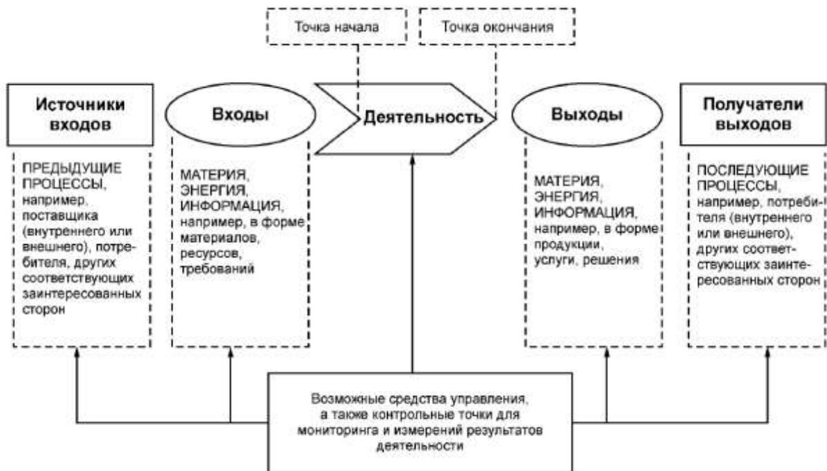
Рисунок 1 – Схематическое изображение элементов процесса
