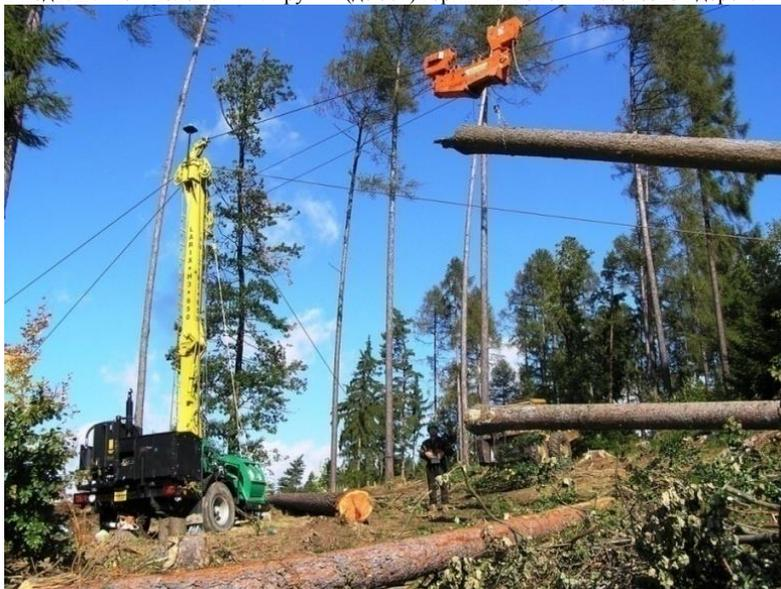
Рисунок 1 - Трелевочная канатная установка LARIXH 3-650
