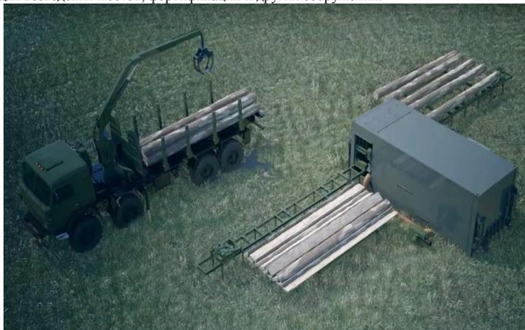
Рисунок 2 - Мобильный лесопильный комплекс ВМЛК-1 в рабочем состоянии
