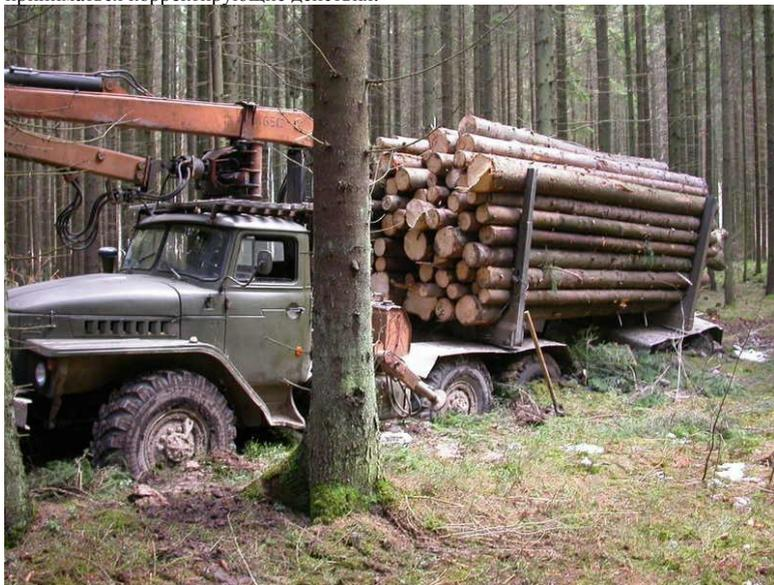
Рисунок 1 – Машина Урал с гидроманипулятором за работой на лесной дороге
