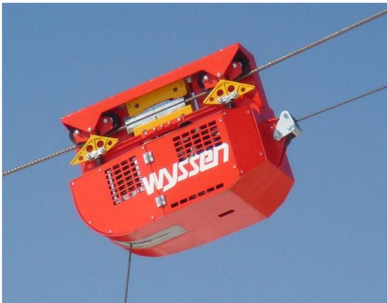
Рисунок 2 - Трелевочная каретка WYSSSEN Slackpuller
