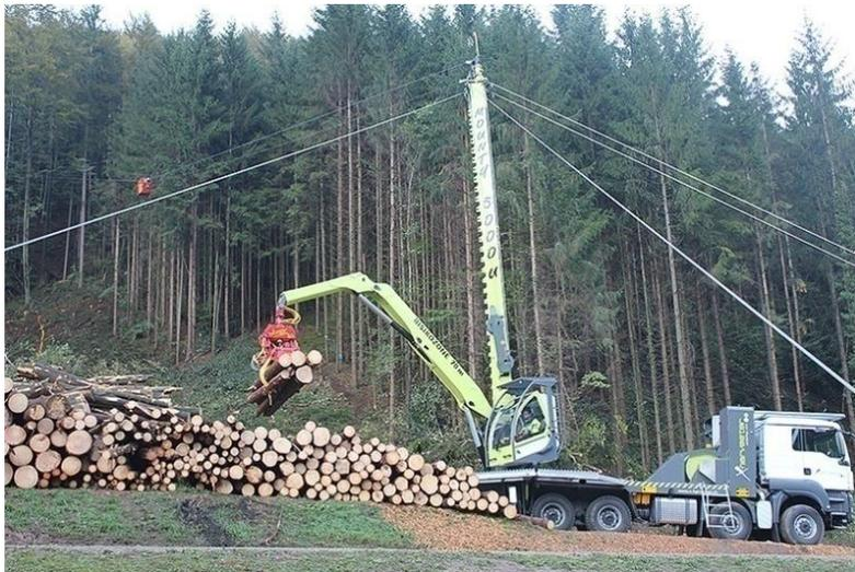
Рисунок 3 - Трелевочно-транспортная канатная установка KonradMOUNTY 50004
