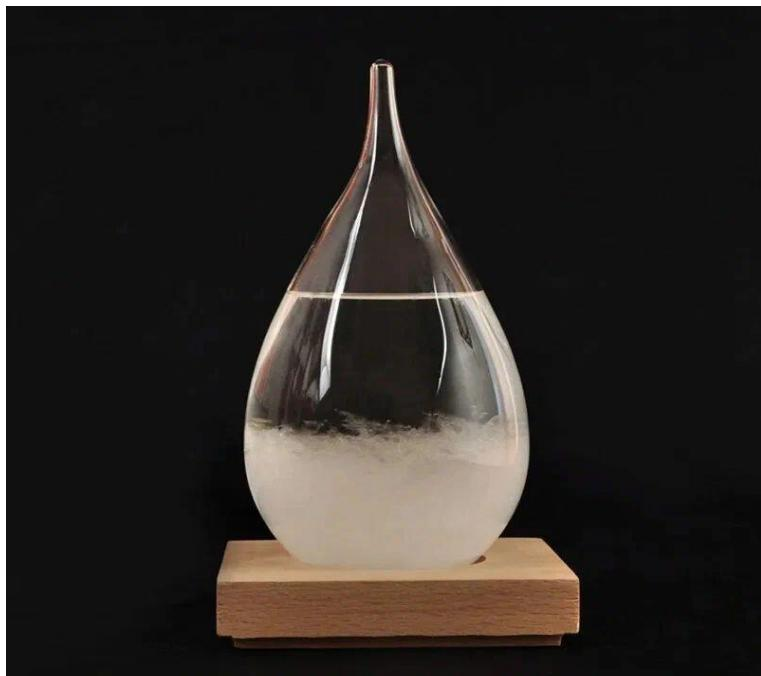
Этот прибор состоит из стеклянной колбы, заполненной спиртовым раствором, в котором в определённых пропорциях растворены камфора, хлорид аммония и калийная селитра. Колба герметически запаяна, но, тем не менее, в ней постоянно происходит рождение и исчезновение кристаллов. По внешнему виду жидкости в приборе якобы возможно предсказывать погоду.
