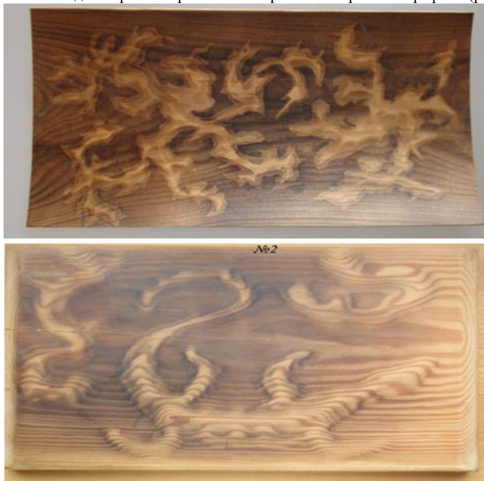
Рис. 2. Фотографии образцов изделий, изготовленных из древесного массива (необработанная сосновая доска) по предлагаемой технологии в режиме термомеханической модификации. Плотность до 1.5 \text{ г/см}^3 , высокая твердость, в результате чего не требуется последующая поверхностная обработка декоративного изделия. Назначение: облицовочная доска для внутреннего и наружного применения, паркетная панель и др.
