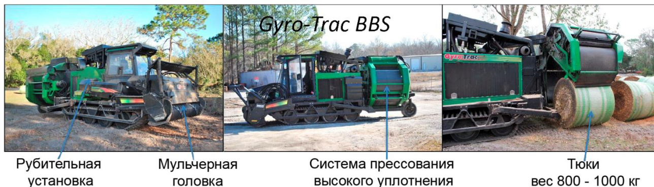
Рис. 5. Основные механизмы мульчера Gyro-Trac BBS (фото Gyro-Trac) [8]
