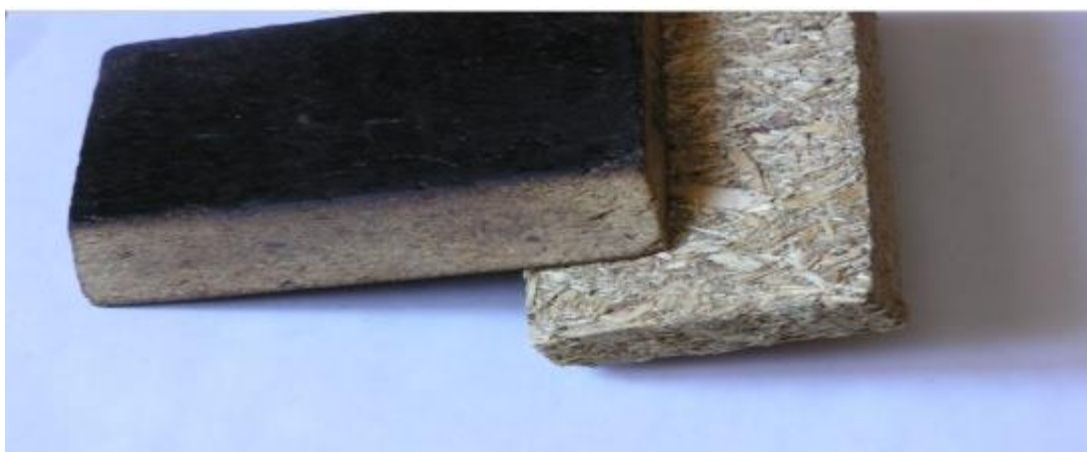
Рис. 1. Фотография изготовленного по предлагаемой технологии образца ДСП (темный) в сравнении с традиционным изделием ДСП на основе фенолоформальдегидного связующего (светлый).
