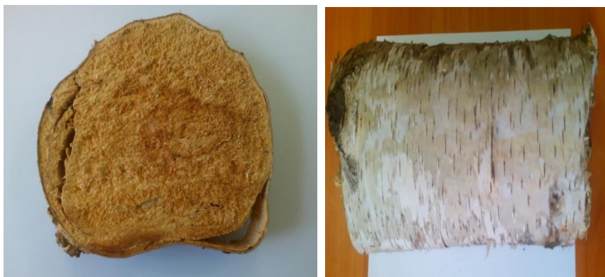
Рис.2. Древесина березы 3-й стадии разрушения грибов «белой гнили» с берестой не подвергнутой разрушению
