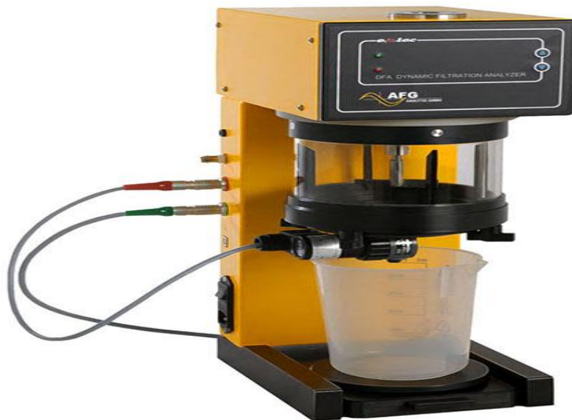
Рис.1. Лабораторная установка для оценки динамического обезвоживания и фильтрация
