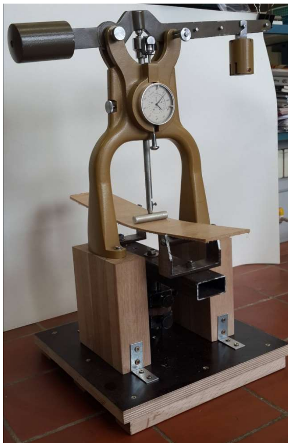
Рис.1. Лабораторная установка для проведения оценки реологических характеристик плитных материалов
