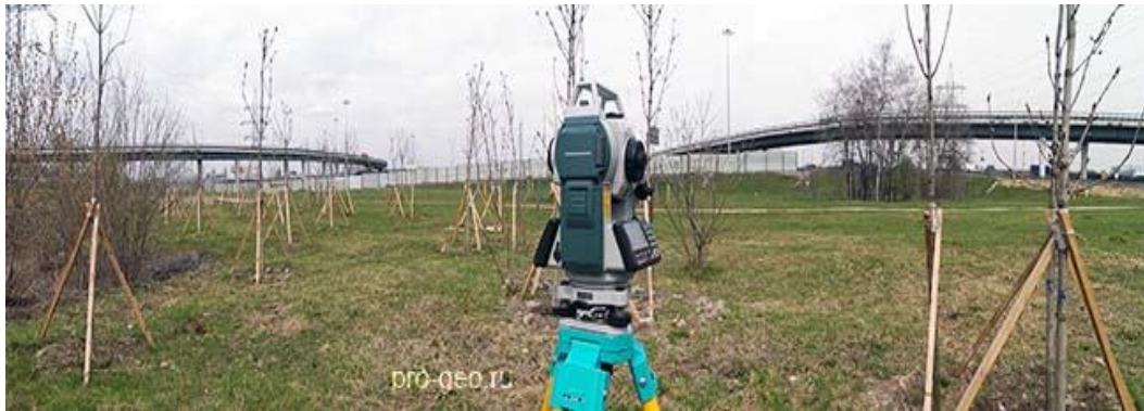
Рисунок 1. Полевая работа по картографированию тахеометром
