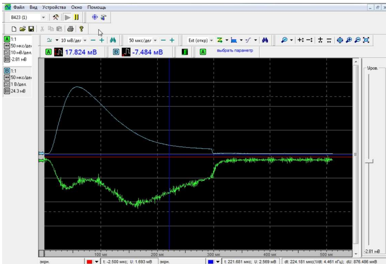
Рис. 11. Осциллограмма излучения линии \text{Ag}^+480,6 в течение разряда
