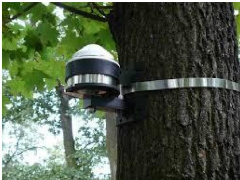
Рисунок 20. Дендрометр DRL26C в рабочем положении
